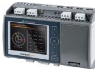
Die Parametrierung der Messung wird entweder über die Tasten am intuitiven TFT-Display oder über einem Webbrowser umgesetzt. In Niederspannungsnetzen sind Nennspannungen bis 690V mit Messkategorie CATIII anschließbar. Zusätzlich ist mittels Ereignisaufzeichnung relevanter Daten die Absicherung der Netzqualität (Power Quality) möglich.
