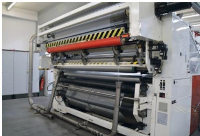
Auch am Extruder wird Technik von Wachendorff eingesetzt. Hier wird die Drehgeschwindigkeit direkt an der Walze abgenommen. Darum konnte der Geber anders montiert werden, und er ist beim Rollenwechsel nicht im Weg.
