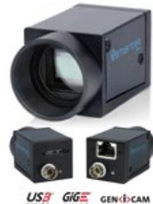
intelligenten Verkehrssystemen (ITS). Die UCC- und GCC-Modelle unterstützen USB3 und GigE Vision und sind über den Bildverarbeitungsexperten Framos erhältlich. Die Kameras bieten eine leistungsstarke Plattform mit einem sehr kleinen Formfaktor von 29 x 29 mm. Mit Standardkonnektivität, erweiterten Processing-Möglichkeiten und einem modularen Konzept können sie flexibel auf individuelle Bedürfnisse angepasst werden.
