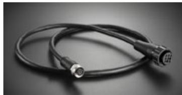
Die 9-polige Version der Bauform 13 entspricht ISO 11783 und eignet sich somit für die Datenübertragung via Isobus, dem maßgeblichen Bus-Standard in der Agrar- und Forsttechnik. Je nach Ausführung erreichen die Steckverbinder einen Schutzgrad bis IP65/IP67 und halten abhängig vom gewählten Kabel Temperaturen zwischen -55 °C und +105 °C stand. Ihre Bajonettverriegelung mit Trapezgewinde weist eine Endverrastung als Vibrationsssicherung auf.
