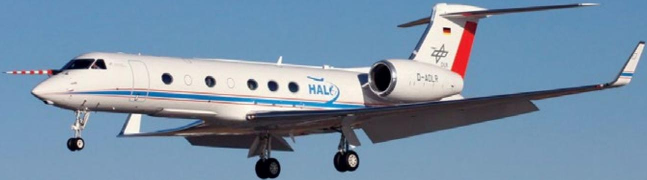
Halo, das Forschungsflugzeug des Deutschen Zentrums für Luft- und Raumfahrt, testet erstmals ein neu entwickeltes Verfahren für die Schwingungsanalyse: Unter realen Flugtestbedingungen sollen die modalen Parameter wie Eigenfrequenz, Eigenform und Dämpfung erfasst und direkt ausgewertet werden. Niedrige Außentemperaturen, große Flughöhen und atmosphärische Bedingungen stellen dabei eine Herausforderung für die Datenerfassung dar.
