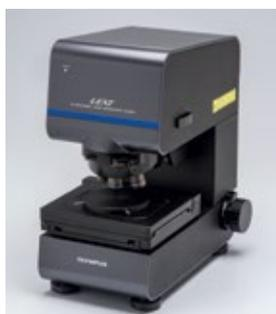
Das neue konfokale 3D-Laser-Scanning-Mikroskop Lext OLS5000 von Olympus spart Zeit und erhöht die Produktivität. Mit speziellen Objektiven, einem verbesserten Scan-Algorithmus und einem erweiterten Probenraum ist das neue Industriemikroskop in der Lage, Proben mit einer Höhe von 0 bis 210 mm flexibel zu erfassen. Das Gerät nutzt einen Peak-Algorithmus zur 3D-Datenmodellierung, der in Kombination mit der intelligenten Skip-Scan-Funktion die Messdatenerfassungszeiten um bis zu
