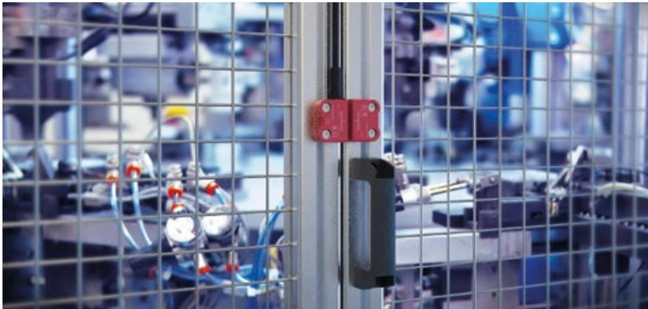
Der SRF (Safety RFID) überwacht beweglich trennende Schutzeinrichtungen, beispielsweise Klappen oder Türen von Schutzgittern
