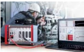
Torsions-, Struktur-, Wellen- oder Verbrennungsschwingungen: Überall dort, wo in technischen Anlagen und Prüfständen dynamische Phänomene auftreten oder untersucht werden, kommt Ifta Argusomds zum Einsatz.
