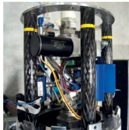
Der Faulhaber-Motor (schwarzer Zylinder) dient als Antrieb des Ventils, das die Zufuhr des Oxidationsmittels regelt.
