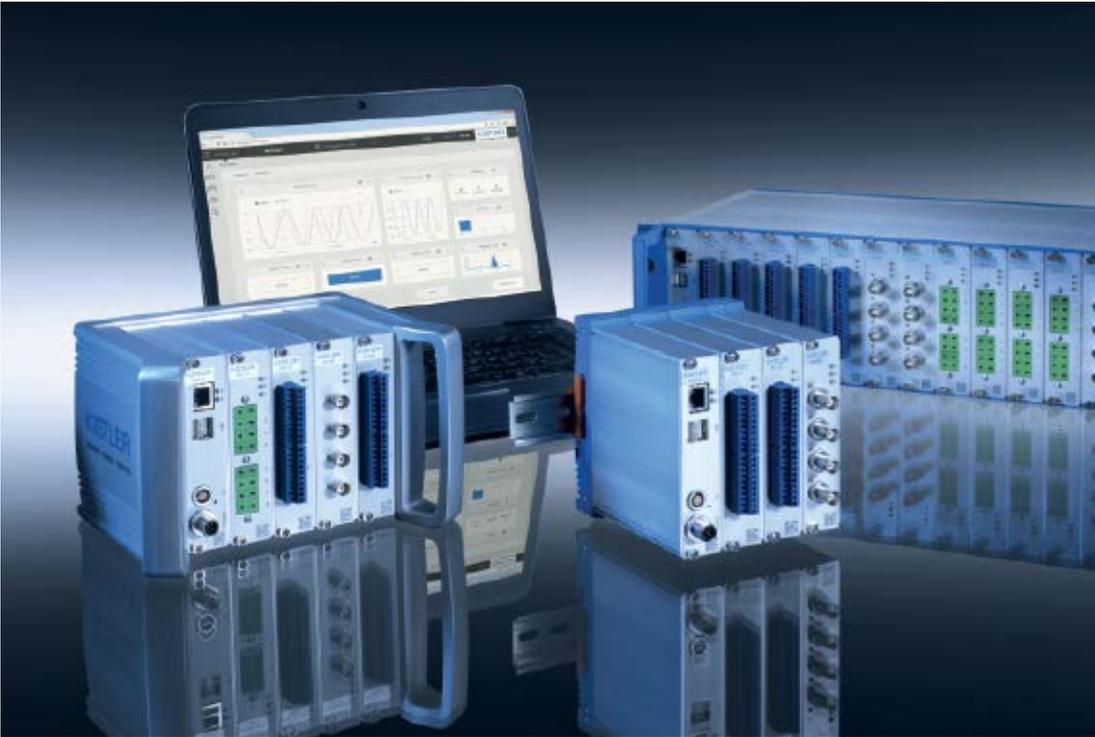
Das Datenerfassungssystem KiDAQ lässt sich jederzeit mit Messmodulen und -einheiten erweitern.
