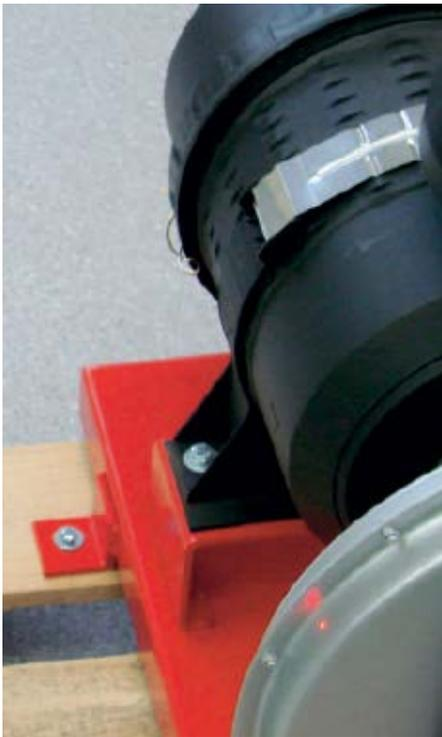
Beispiel für eine Messung mit einem Laser-Doppler-Vibrometer an einem Elektromotor
