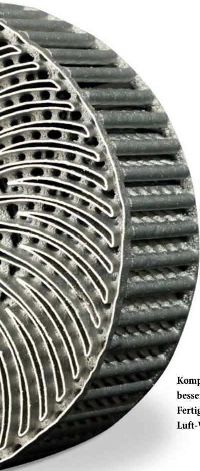
**Komplexe Formen lassen sich im 3D-Druck besser herstellen als bei konventionellen Fertigungsmethoden: Hier ein Flüssigkeit-Luft-Wärmetauscher.**
