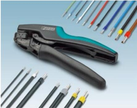
**Genormter Leistungsumfang: die Crimpfox Duo 10 verarbeitet Aderendhülsen gemäß DIN 46228-1/-4 im Querschnittsbereich von 0,14 bis 10 mm<sup>2</sup> sowie Twin-Hülsen gemäß UL 486F von 2 x 0,5 mm<sup>2</sup> bis 2 x 4 mm<sup>2</sup>.**
