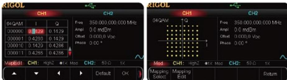
Neben einer Vielzahl an analogen Modulationsformen lassen sich mit dem IQ-Vektor-Generator (Inphase/Quadratur) unterschiedliche Modulationen bis zu 64QAM pro Kanal und diversen Codesequenzen erstellen.
