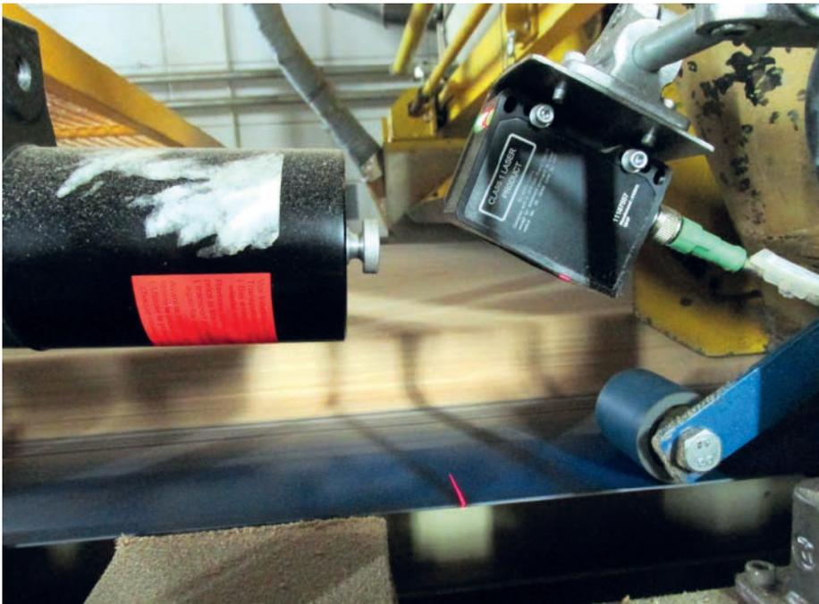
Die maximal 70 mm breite Laserlinie des Sensors erfasst kontinuierlich die Bahnkante, wobei das Gerät über seinen Analogausgang die jeweils aktuellen Messwerte an die SPS der Presse übermittelt.
