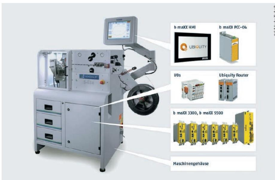
In der 3D-Augenrandbiegemaschine S-514 finden alle kompakten Antriebskomponenten von Baumüller Platz.
