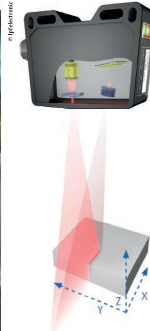
Lasersensoren der Reihe PY74 basieren auf dem Lichtschnittverfahren. Ein intelligenter Algorithmus gepaart mit Koordinatentransformation ermöglichen Messungen ohne aufwändige Sensorausrichtung.
