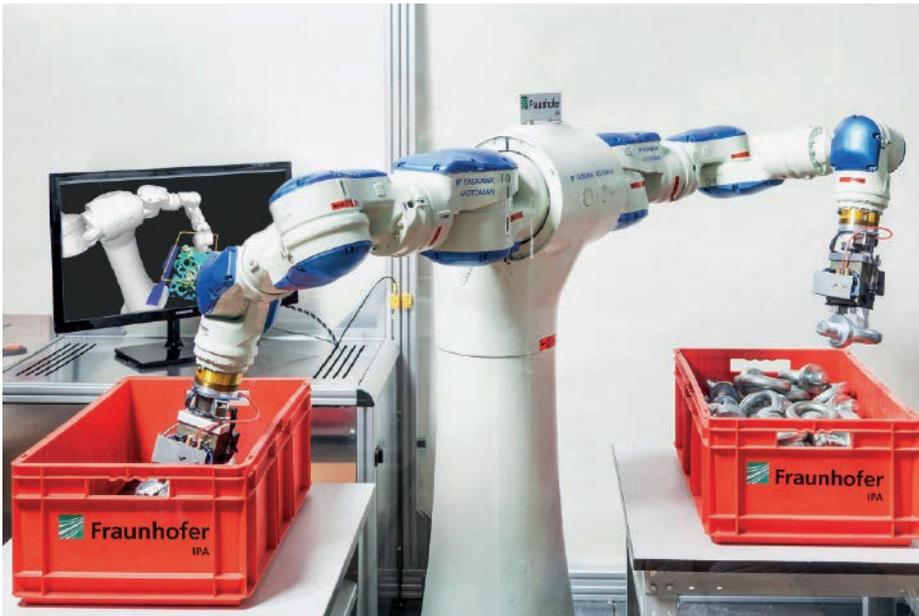
Maschinelle Lernverfahren helfen, dass Roboter den Griff-in-die-Kiste schneller und zuverlässiger ausführen. (Bild: Fraunhofer IPA/Foto: Rainer Bez)
