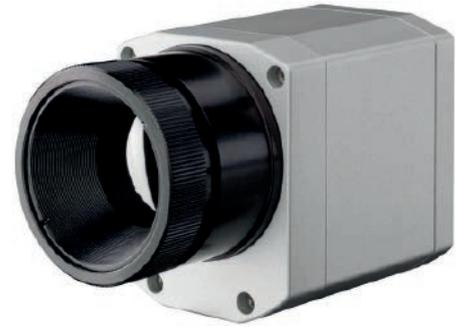
Die Kamera PI 640 hat eine Auflösung von 640 x 480 Pixel. Für jeden Bildpunkt messen die Infrarotkameras einen eigenen Temperaturwert mit bis zu 125 Hertz.
