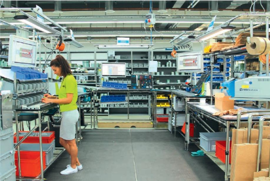
**Klemmenleistenfertigung im Fluss: Die Gestaltung von Fertigungssystemen nach dem Fließprinzip minimiert die Durchlaufzeit.**
