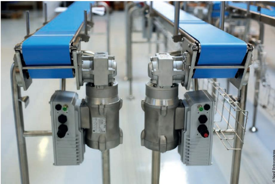
Die Glattmotoren von Nord Drivesystems sind speziell für die leichte Reinigung konstruiert. Sie verfügen über ein washdown-optimiertes Aluminiumgussgehäuse und haben fließende Flächenübergänge.
