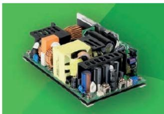
Emtron vertreibt ab sofort die EPP-500-Serie mit 500 W Ausgangsleistung von Mean Well. Zu den wesentlichen Charakteristika der Serie EPP-500 zählen die geringe Größe (5" x 3"), 500 W Ausgangsleistung bei 25 CFM forciertes Lüftung, 320 W Ausgangsleistung mit Kühlung durch freie Luftkonvektion, 550 W
