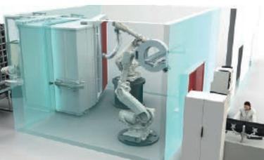
Die XRHRobotPipe ist ein vollautomatisches System zur zerstörungsfreien Prüfung (ZfP) von Titan-Schweißnähten mittels Röntgentechnologie. Das System erkennt den Bauteiltyp automatisch und führt die Prüfung ohne Bedie-
