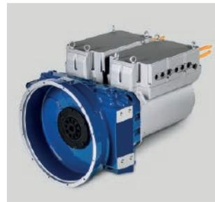
Auf der diesjährigen Power2Drive-Messe in München präsentiert STW ein neues Antriebspaket für Nutzfahrzeuge mit einer Leistung von 160 bis 280 kW. Dabei handelt es sich um zwei elektrische Motoren mit jeweils 80 oder 140 kW. Die Motoren treiben das Summiergetriebe an, welches wiederum die Kraft auf das Standardgetriebe des bestehenden Nutzfahrzeugs überträgt. Damit lässt sich die Idee „Diesel
