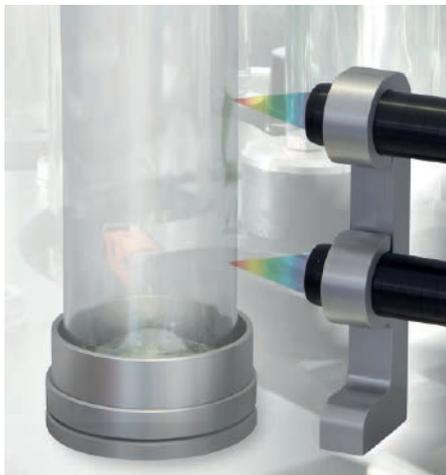
Für den Prüfprozess werden die Flaschen rotierend an zwei konfokal-chromatischen Sensoren vorbeigeführt. Diese messen die Dicke der Flaschen an zwei Stellen synchron und mit einer Genauigkeit von 10 µm.
