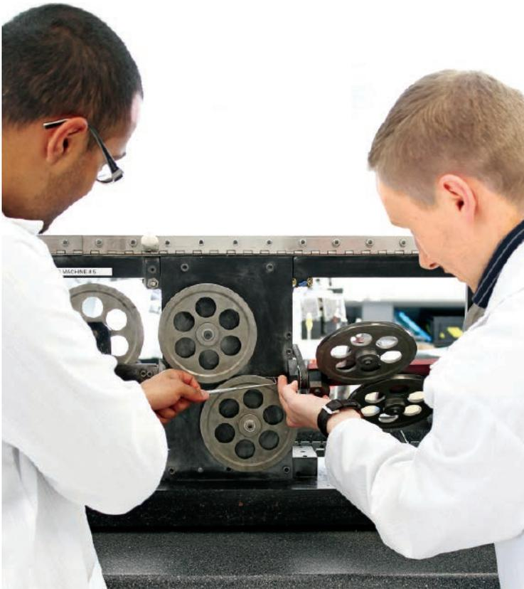
Wiegand-Maschine in Aachen: Ein komplexes Spulensystem sorgt für die passgenaue Konditionierung bzw. Umformung des Drahtes.
