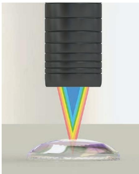
Das konfokal-chromatische Messsystem, bestehend aus dem Sensor ConfocalDT IFS2405-3 und dem Controller ConfocalDT IFC2461, prüft die Mittenstärke von dünnen optischen Linsen sowie deren Kontur beziehungsweise Krümmung.
