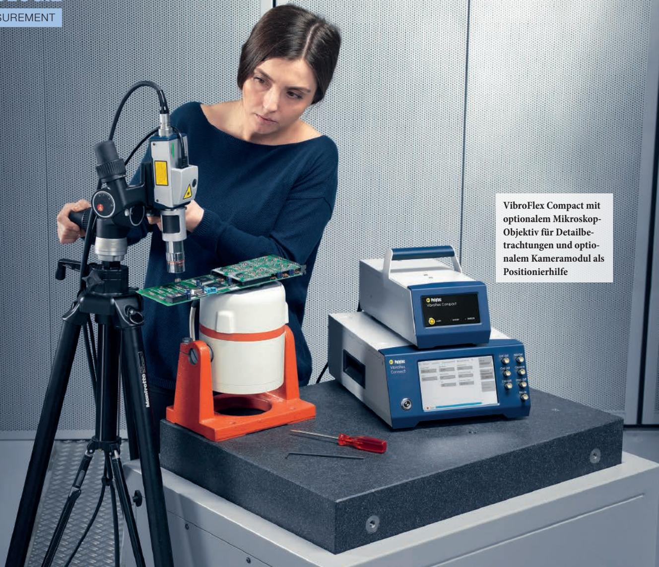
VibroFlex Compact mit optionalem Mikroskop-Objektiv für Detailbeobachtungen und optionalem Kameramodul als Positionierhilfe
