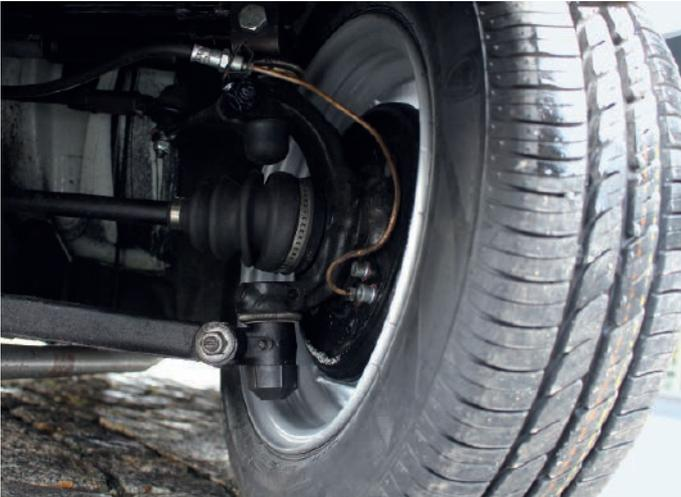
Blick unter den Trabi: Die Spurstangen schwenken den Achsschenkel. In die Achsschenkel eingepresst sind die verschleißfesten und wartungsfreien Iglidur-J-Gleitlager.
