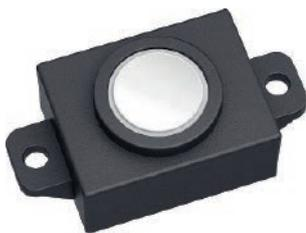
Unitronic stellt das Ultraschall-Distanzmesmodul UMM0090 von Audiowell Electronics vor. Das Modul UMM0090 misst das Zeitintervall zwischen dem Senden der Ultraschallimpulse und dem Empfangen des Echos, um den Abstand zu nahegelegenen Objekten zu bestimmen. Der Abstandswert wird durch die Pulsweite der Ausgangssignale angezeigt. Die gemessenen Daten werden mittels eines LoRa-Netzwerkes
