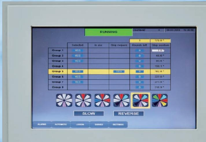
Über die webbasierte Visualisierung kann der Bediener die Beladung des Riesenrads überwachen.
