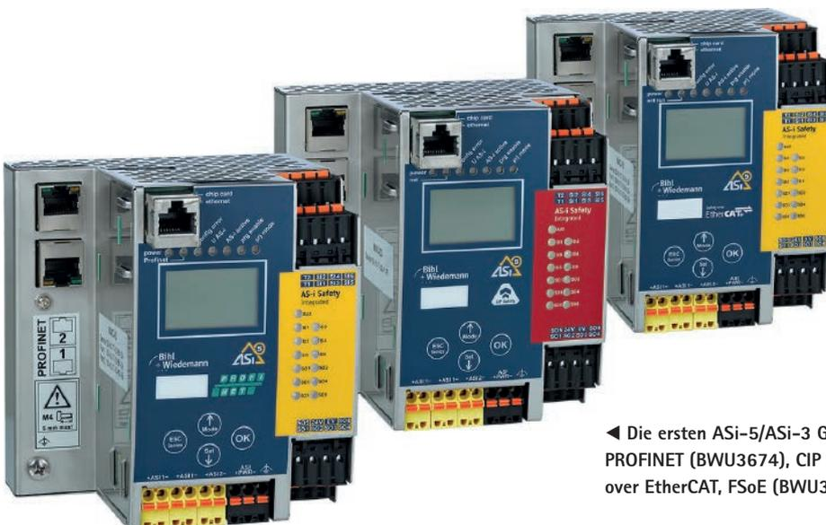
◀ Die ersten ASi-5/ASi-3 Gateways von Bihl+Wiedemann für PROFISafe über PROFINET (BWU3674), CIP Safety über EtherNet/IP (BWU3857) und Safety über EtherCAT, FSoE (BWU3858)
