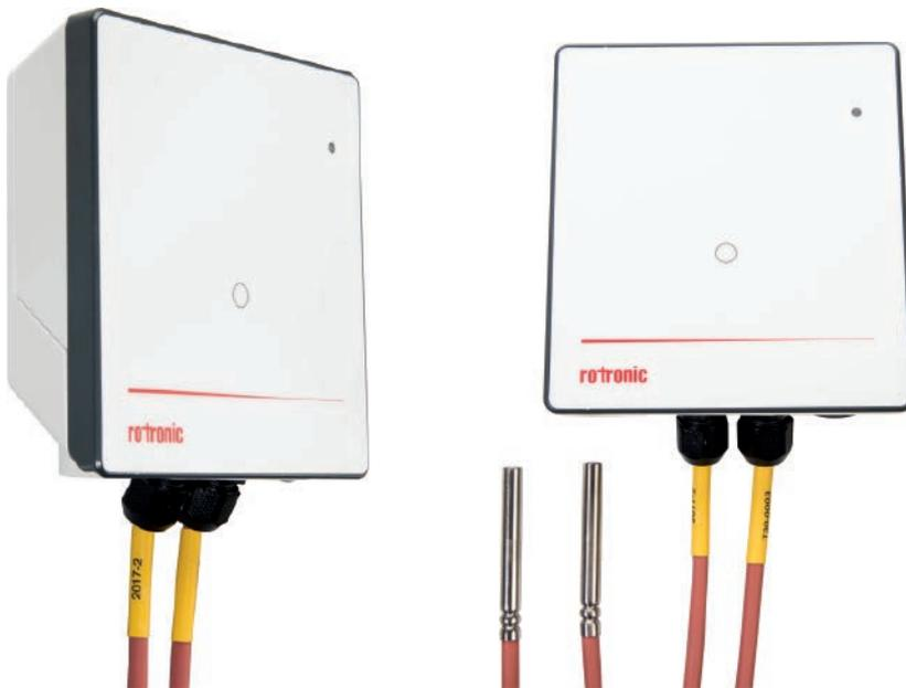
An den Datenlogger RMS-Log-T30 können zwei PT100-Sensoren angeschlossen werden. Er speichert 44.000 Messwertpaare und sendet diese per LAN- oder Funkschnittstelle an die RMS-Datenbank.
