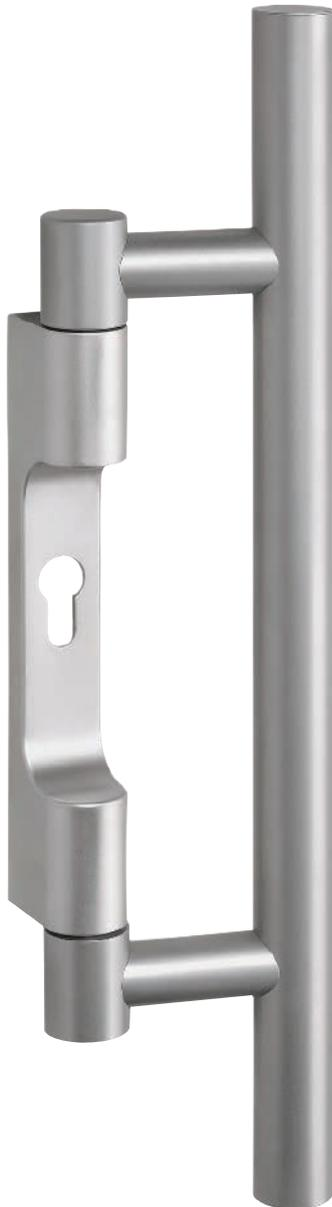
Es ist eine komfortable Lösung für Haus-Eingangstüren von Mehrparteiengebäuden: der schwenkbare Stoßgriff in Kombination mit einem ÜLock-Schloss von Süd-Metall. Mit Hilfe eines I/O-Moduls wird über die Türöffnerfunktion der Sprechanlage die Haustür per Funk angesteuert. Durch Drücken oder Ziehen am Stoßgriff lässt sich dann – dank der über Funk eingekoppelten Nusshälften – die Tür öffnen.
