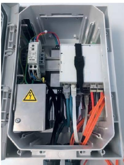
SYNAPS IP 24V (200x300x150 mm) mit standardmäßig integrierter DC-USV, Li-Ion Backup (10 Jahre Lebensdauer) und 2-Port Ethernet-Switch. Optional wurde hier ein 2-Port Glasfaser-Konverter aus dem SLAT-Zubehörsortiment verbaut. Einsatz in der Outdoor-Videoüberwachung
