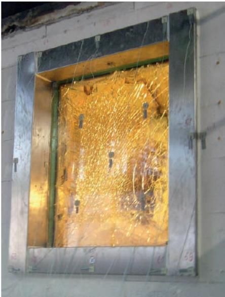
Die Festverglasung F120 ist eine neue Eigenkonstruktion von Wurster. Die Scheibe ist circa 1,13 x 1,28 m groß, 115 mm stark und wiegt etwa 250 kg. Umfasst wird sie von einer Stahl-Rahmenkonstruktion mit Blenden aus Edelstahl. Somit kann sie in Mauern ab 200 mm Wandstärke und Öffnungen von 1064 x 1214 mm verbaut werden. Machbar ist das auch in anderen Größen, allerdings sollte man dann das enorme Gewicht berücksichtigen.
