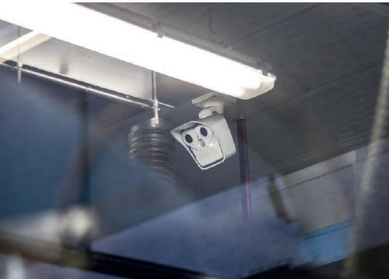
Kameras von Mobotix überwachen jetzt den Produktionsprozess auf kritische Temperaturen und greifen selbständig in den Produktionsprozess ein
