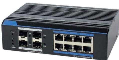
Der ALL-SGI8210v2PM von Allnet ist ein 8-Port Gigabit Industrie Smart-managed-Switch mit Po-E Support auf allen Kupfer-Ports und ist bestens für die gleichzeitige Daten- und Stromversorgung von IP-Kameras oder anderer Po-E-Geräte geeignet, die bis zu 30 Watt benötigen. Der Switch kann über Gigabit Kupfer oder vier optische SFP-Ports an die Infrastruktur angebunden werden. Für die Po-E-Geräte stehen 8 Gigabit Ports zur
