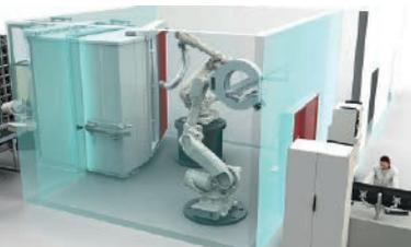
Die XRHRobotPipe ist ein vollautomatisches System zur zerstörungsfreien Prüfung (ZfP) von Titan-Schweißnähten mittels Röntgentechnologie. Das System erkennt den Bauteiltyp automatisch und führt die Prüfung ohne Be-
