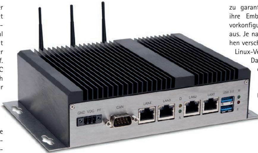
Schnittstelle bereit. Dank integrierter Gigabit-Ethernet-Schnittstellen und WiFi-Unterstützung eignet sich der Box-PC auch als IoT-Gateway oder Datenlogger in der industriellen Automation.
