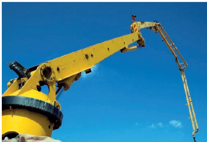
Bei Arbeitsdrücken bis zu 400 bar überwachen zwei hochdruckfeste Sensoren in den Zylindern auf der Ölseite die exakten Endstellungen der Hydraulikkolben im Zylinder. (Bild: Guter/Dreamstime)
