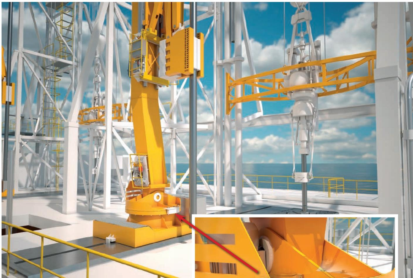
Drehgeber der 78E-Baureihe zur Positionsüberwachung des Pipe-Handlers
