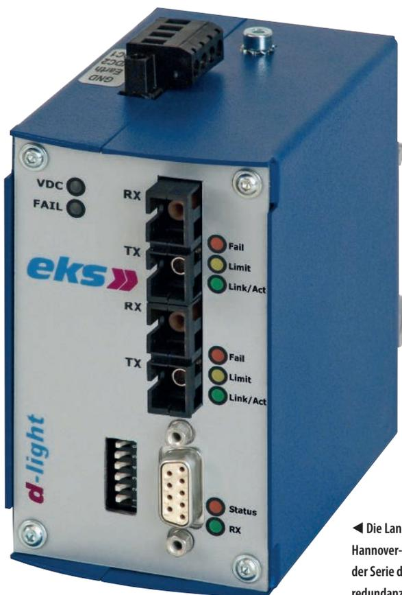
◀ Die Landeeinrichtungen des Verkehrsflughafens Hannover-Langenhagen sind über Medienkonverter der Serie d-light 232 angebunden, die schnelle Ringredundanz unterstützen.
