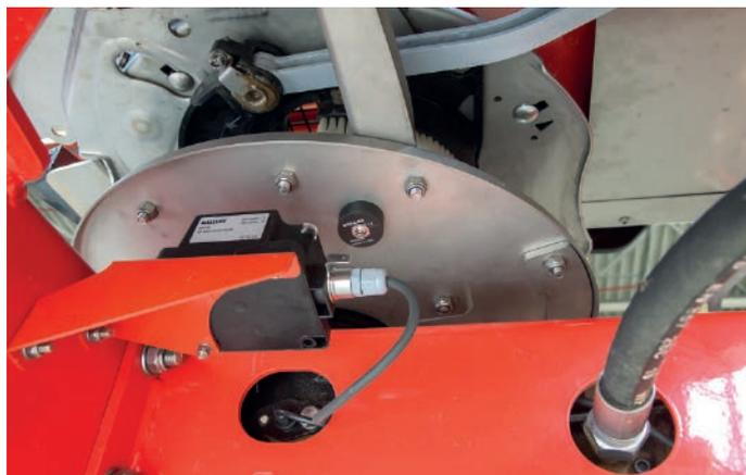
**Der Landmaschinen-Hersteller Rauch stattet Wurfscheiben mit einer RFID-Technologie aus: Dabei wird ein Hochfrequenz-Datenträger unter der Scheibe und die Leseinheit am Getriebe des Düngerstreuers befestigt. Auf dem Datenträger sind der Scheibentyp, dessen Größe und das Herstellungsdatum gespeichert.**
