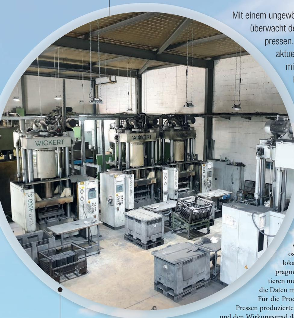
Mit einem ungewöhnlichen und individuell entwickelten Konzept überwacht der Bremsbelagspezialist Frima seine Heißpressen. In den SPS der Maschinen wird die jeweils aktuelle Auslastung mittels eines selbst programmierten Stückzählers erfasst und über ein System bestehend aus IO-Link-fähigen Gateway, integrierter SIM-Karte für NB-IoT und 2G in die Cloud übertragen. So lassen sich ohne einen einzigen Sensor die Funktion der Pressen in Echtzeit überwachen und die Produktionsplanung optimieren.
