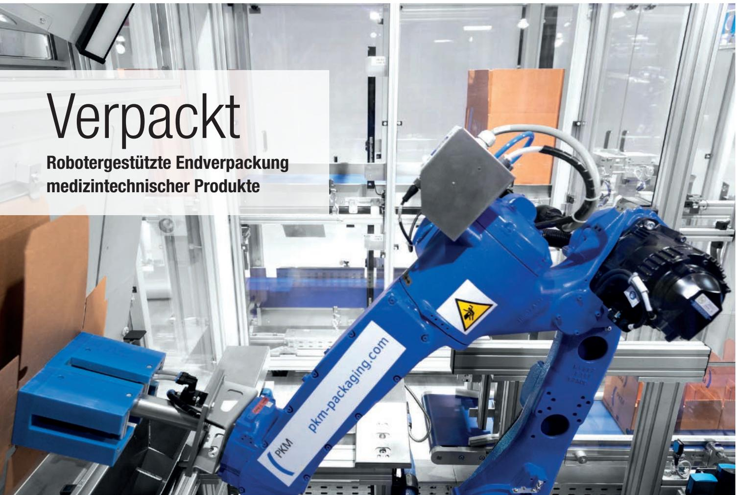
Eine Endverpackungslinie von PKM Packaging hat einen täglichen Output von über 400.000 Einheiten. Für die Dynamik bei der Verpackung der Desinfektionskappen für die Verwendung in der Dialyse sorgen fünf Roboter.
