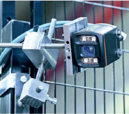
▲ Der 3D-Sensor überwacht von oben mehrere Positionen gleichzeitig.
