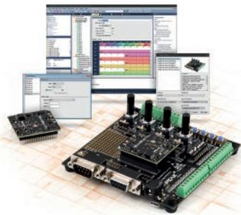
Mit dem PCAN-MicroMod FD hat Peak-System Technik eine universelle Lösung für die Integration einer CAN-FD-Schnittstelle und I/O-Funktionalität in eigene Hardware veröffentlicht. Entwickler können das CPU-Modul in ihre Grundplatine einstecken und mit der im Lieferumfang enthaltenen Windows-Software PCAN-Micro-
