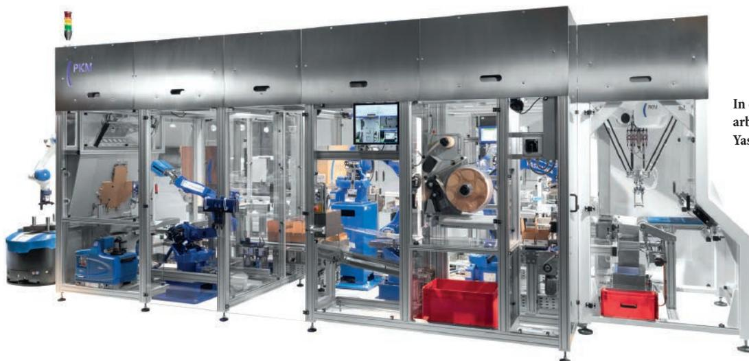
In der kompakten Verpackungszelle arbeiten insgesamt fünf hochdynamische Yaskawa-Roboter.
