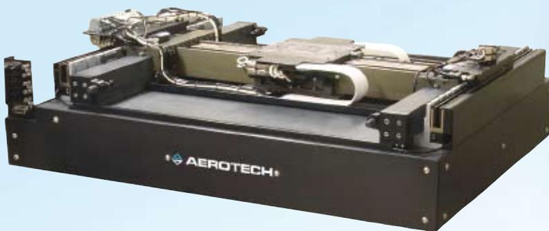
Wenn Sie mit dem Durchsatz an Wafern mit Ihrer Luftlager-Prozessplattform unzufrieden sind, hat Aerotech für Sie mit dem Planar<sub>HD</sub> eine Lösung. Das auf hohe Dynamik und hohen Durchsatz optimierte Design ermöglicht Scan-Geschwindigkeiten bis 2 m/s bei 5 g Beschleunigung und ist geeignet für Wafer bis 450 mm Durchmesser. Da hohe Dynamik und hohe Präzision von Anfang an Designziel waren, gibt es diesbezüglich keine Schwachstellen.
