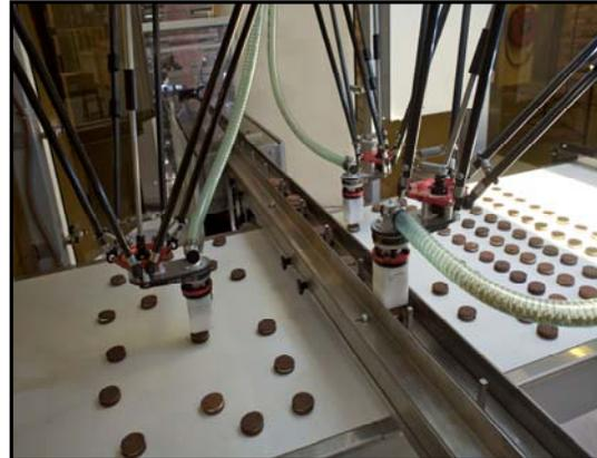
Optisch geführte Roboter sind durchaus üblich. Die Kamera erfasst ein Bild und Software verarbeitet das Bild. In dieser Anwendung (Sortieren von Gebäckteilen) platziert der Roboter unterschiedlich geformte Teile zum Verpacken in einen Blister. Mit Hilfe der Bildverarbeitungssoftware wird die korrekte Form der Teile bestimmt, sie werden indiziert, so dass der Behälter nicht überfüllt wird, und dann die Koordinaten zum Roboter übertragen. Mit freundlicher Genehmigung: Bosch Packaging Technology
