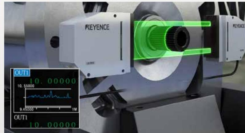
Rundlaufmessung am Elektromotor eines Hybridfahrzeugs
