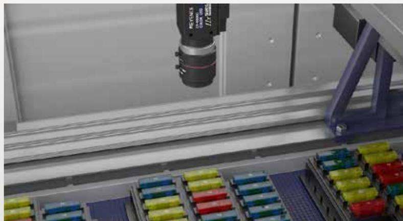
Montagekontrolle von Flachstecksicherungen
