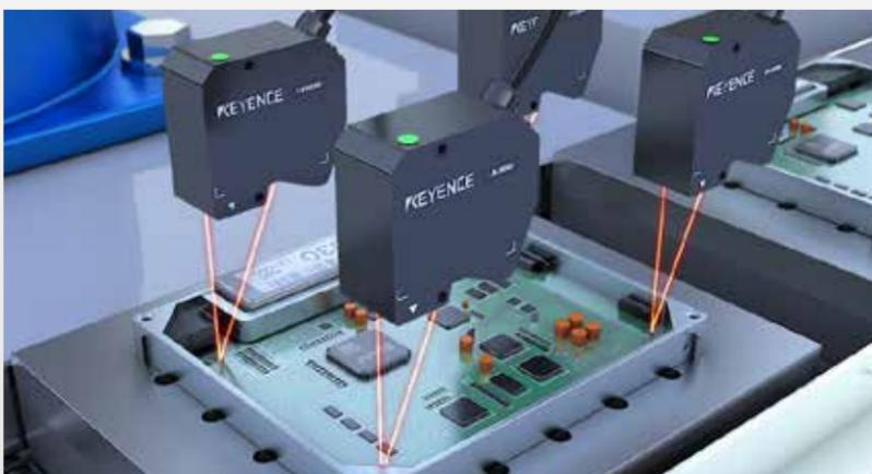
Überprüfung der korrekten Montage von Antriebssteuerungsmodulen
