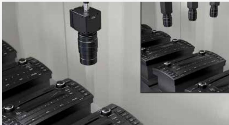
Typenidentifikation und Oberflächenprüfung von Bedieninstrumenten (21 MP)
