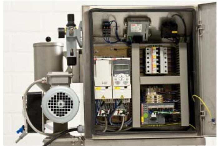
**Hansa Industrie-Mixer setzt beim neuen Labor-Mixer auf eine speicherprogrammierbare Steuerung und auf Frequenzumrichter von ABB.**
