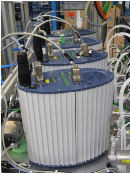
Im Gegensatz zur klassischen Helium-Dichtheitsprüfverfahren sind die T-Guard-Systeme kompakter, günstiger und einfacher in die Anlagen zu integrieren.
