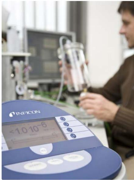
Nach 5,6 Sekunden Prüfzeit ist bekannt, ob das Gas-einblasventil dicht ist - das Ergebnis lässt sich direkt am Display des Geräts ablesen.
