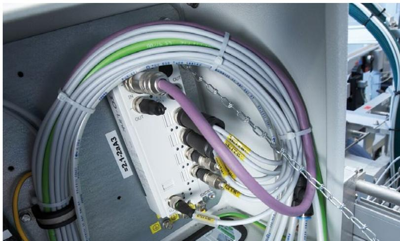
Einige Lichtschranken von SICK sind über ein IO-Link-PROFIBUS-Modul angebunden und unterstützt von SICK-eigenen Sensorfunktionsblöcken in eine ELAU-Steuerung integriert.
