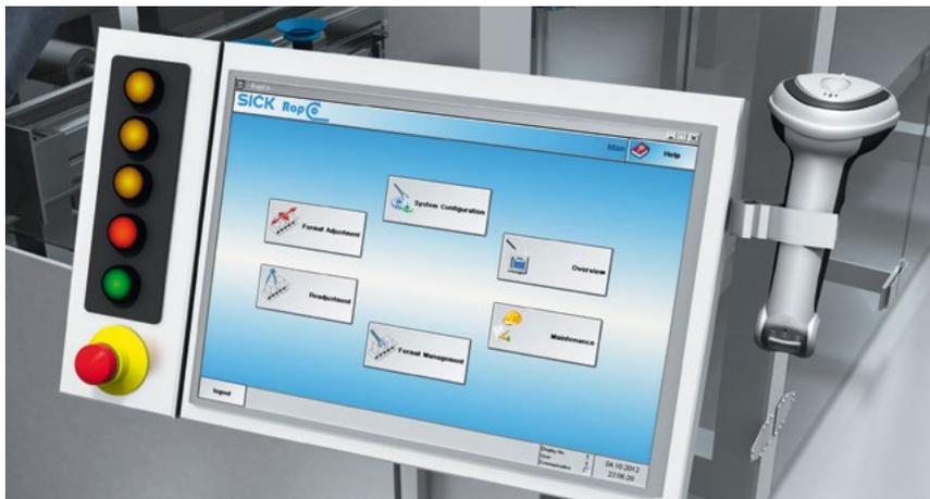
Konfigurieren und parametrieren statt programmieren: Anlagenspezifische Einstellungen sowie Wartung und Diagnose werden zentral über den Touchscreen vorgenommen
