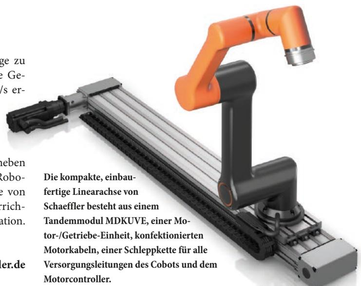
Die kompakte, einbaufertige Linearachse von Schaeffler besteht aus einem Tandemmodul MDKUBE, einer Motor-/Getriebe-Einheit, konfektionierten Motorkabeln, einer Schleppkette für alle Versorgungsleitungen des Cobots und dem Motorcontroller.
