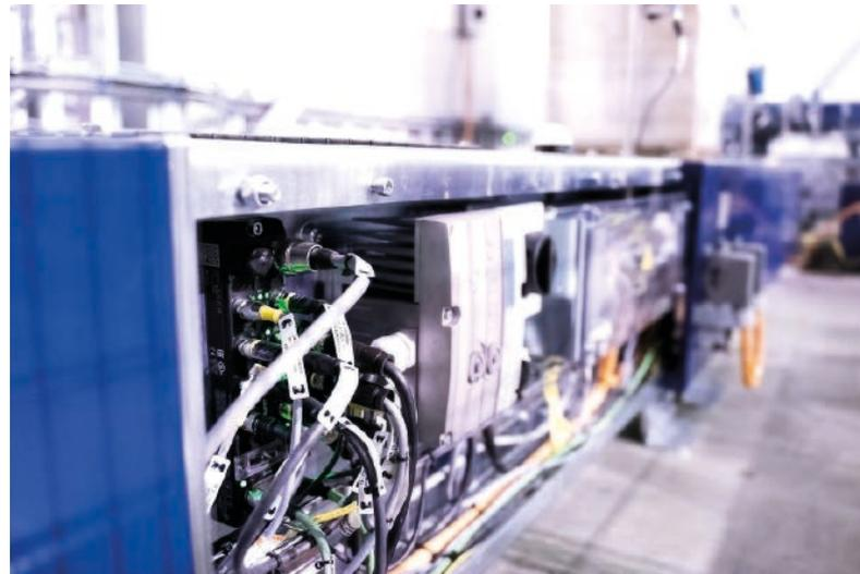
Jedes Fördererelement hat eine eigene Steuerung: Turcks IP67-PLCs sind bei -25 °C Umgebungstemperatur direkt an der Strecke montiert.
