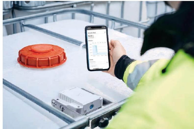
**Digitale Füllstandsüberwachung von Kunststofftanks:**
