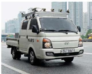
Vor kurzem ist ein Mini-LKW von Seoul nach Busan vollautonom gefahren. Zum Schutz der Dachkamera setzte das von Marsauto gebaute Fahrzeug auf die Kameraschutzgehäuse der Salamander-Serie von Autovimation. Die robusten Gehäuse mit zylindrischer Innenform und Schutzart IP 66/67 zeichnen sich durch kompakte Abmessungen mit geringem Eigengewicht und eine gute Wärmeableitung aus. Die Schutzgehäuse sind für Kamera-Querschnitte von
