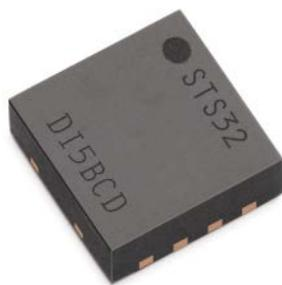
Sensirion hat den Temperatursensor STS32 vorgestellt. Dieser digitale Sensor wird mit einem ISO-17025-akkreditierten Dreipunkt-Kalibrierzertifikat geliefert. Der STS32 basiert auf der vielseitigen STS3x-Plattform und ist ein digitaler, I2C-basierter Temperatursensor. Er verfügt über eine an die GDP angepasste Genauigkeitsspezifikation und ein mitgeliefertes Dreipunkt-Kalibrierzertifikat,
