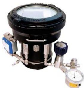
Mit dem tragbaren CDP301 Condumax bringt Michell Instruments einen neuen Taupunktanalysator für die Qualitätskontrolle bei Verarbeitung und Transport von Erdgas auf den Markt. Basierend auf der Taupunktspiegeltechnologie gestattet das optisch-visuelle Messgerät wiederholbare und hochgenaue Messungen des Kohlenwasserstoff- und Wassertaupunkts, um die Anforderungen des DVGW-Arbeitsblatts
