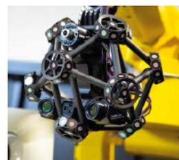
Creaform stellte zudem das VXscan-R-Softwaremodul für digitale Zwillingsumgebungen vor, welches das Paket für schlüsselfertige, automatisierte Qualitätssicherungs-lösungen des Unternehmens ergänzt. Eines der Features des Produkts ist die kurze Zyklusdauer: Mit 45 blauen Laserlinien für einen hochdichten Scanbereich, der bis zu 1.800.000 Messungen pro Sekunde durchführt und Live-Netze erzeugt, ist es schnell.
