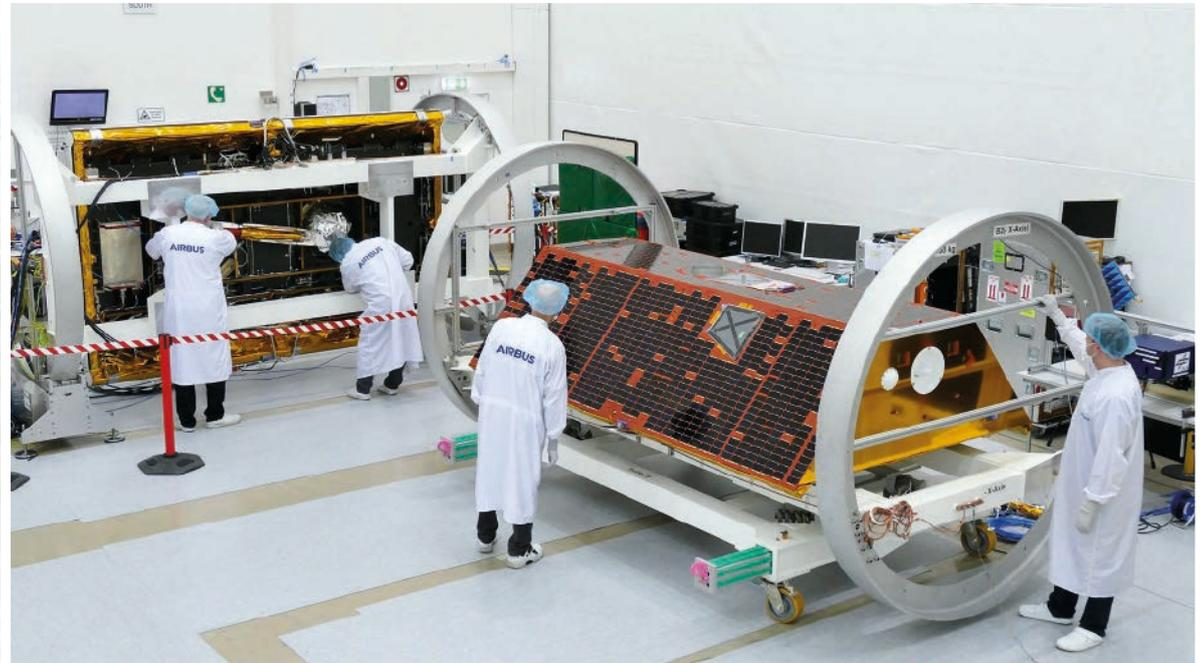
Gebaut wurden die GRACE-Zwillinge sowie deren Nachfolger von Airbus. Für die Lagekontrolle und die Bestimmung von nicht-gravitativen Störkräften haben beide Satelliten Sternsensoren und Beschleunigungsmesser an Bord.
