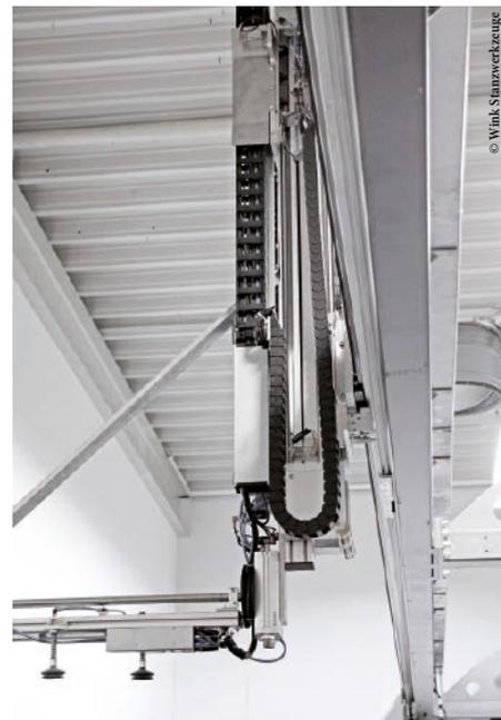
Aufgrund der niedrigen Deckenhöhe wurde die Z-Achse teleskopierbar ausgeführt. Vorteil: halbe Länge bei gleichem Hub.
