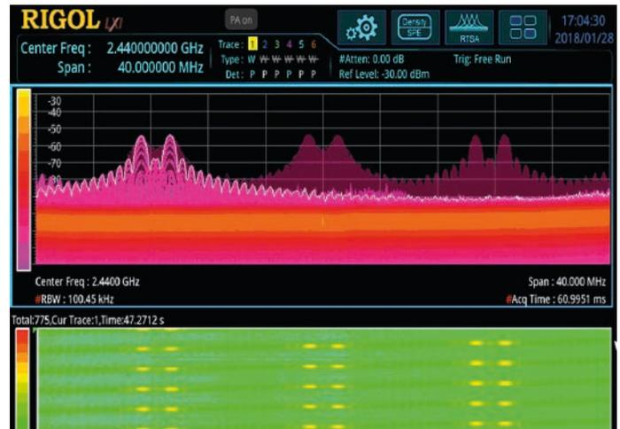
Abb. 1: RSA Dichtigkeit in Kombination mit Spektrogramm
