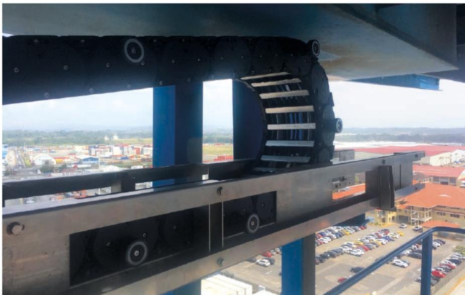
Der Kettenbogen der TKHD RSC in Schubendposition – die Laufrollen sind optimal zum Kanal justiert.
