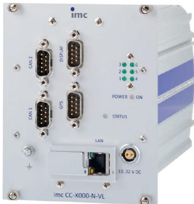
Die Imc-C-Serie bietet eine hohe Abtastrate und erfasst Signale bis in den  $\mu$ s-Bereich.
