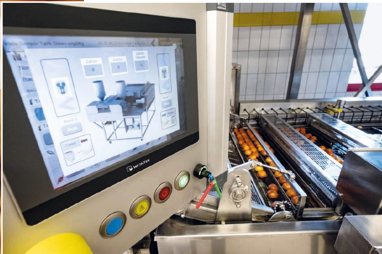
Das smarte All-in-One-HMI von Wachendorff vereint drei Funktionen in einem Gerät: Bedienung, Remote-Access, Cloud-Anbindung.
