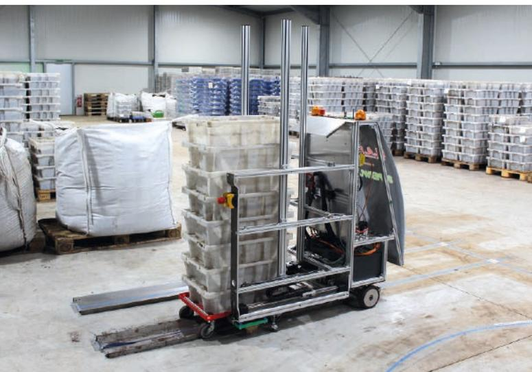
Fahrerloses Transportsystem (hier ohne Seitenschutz) holt Eurocontainer aus dem Lager. Nächster Halt ist die neue Fütterungs- und Bewässerungsanlage.
