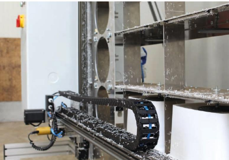
Die Energiekette E4 von Igus sorgt für sichere Leitungsführung am Drylin-Portal des Eimerbohrers.
