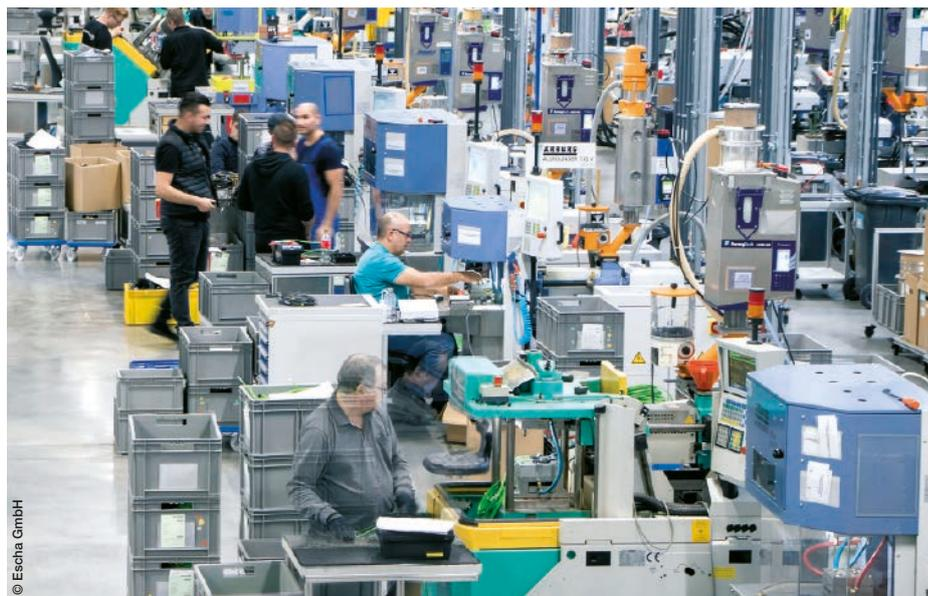
Escha konfektioniert teilautomatisiert die Stecker an die CFSpecial.414 von Igus.
