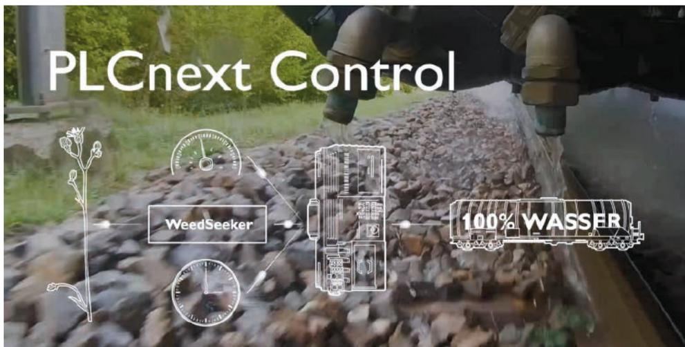
Die PLCnext Control AXC F 2152 erhält die Position und Größe des Unkrauts von Sensordaten und öffnet das Ventil des Heißwasserwaggons dann punktgenau.
