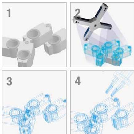
Eine einfache Inbetriebnahme mit innovativem Einlernen von Neuteilen wird mit der Funktion „Teach-from-Scan“ zusätzlich zum „CAD-Teach-in“ ermöglicht.
