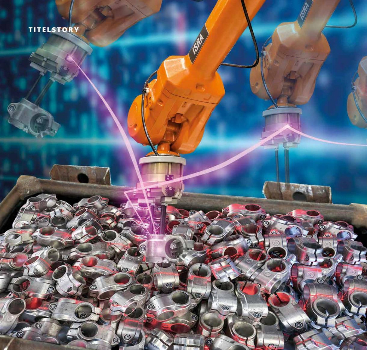
Eine optimierte Roboterbahnberechnung und die Multi-Pick-Funktion gehören zu den wesentlichen Faktoren eines schnellen und zuverlässigen Bin-Picking-Prozesses.
