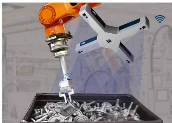
Der von Isra Vision entwickelte Sensor Powerpick 3D erkennt Teile zuverlässig – unabhängig von Geometrie oder Material.
