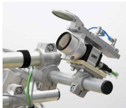
VMT 3D kann zur berührungslosen Lageerkennung ganzer Fahrzeugkarossen, aber auch von Blechteilen aus dem Presswerk, von Front-, Heck- und Bodenbaugruppen sowie von Anbauteilen wie Türen oder Seitenwänden eingesetzt werden.
