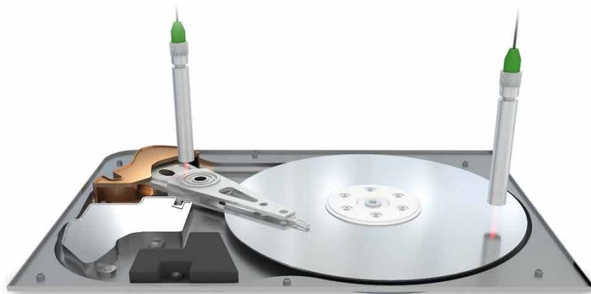
Das Weißlicht-Interferometer liefert absolute Messwerte und ermöglicht präzise industrielle Abstandsmessungen. Das System erfasst auch Stufen und Kanten zuverlässig.
