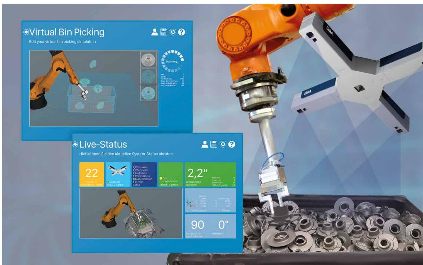
Der virtuelle Bin-Picking-Prozess inklusive des Zellenlayouts und der Roboterbahnplanung spart Zeit und Kosten in der Vorbereitungsphase.
