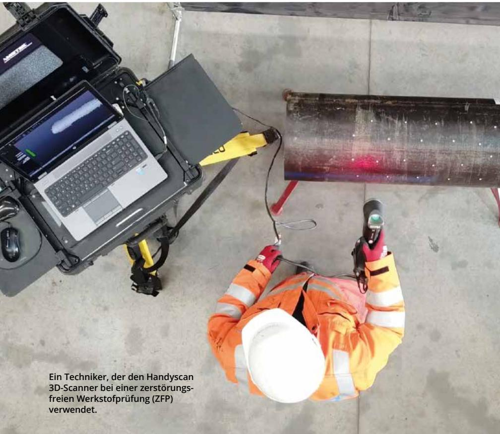
Ein Techniker, der den Handyscan 3D-Scanner bei einer zerstörungsfreien Werkstoffprüfung (ZFP) verwendet.
