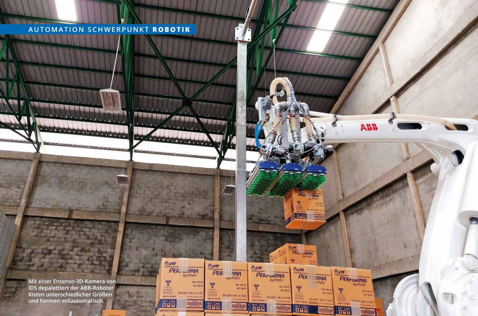
Mit einer Ensenso-3D-Kamera von IDS depalettiert der ABB-Roboter Kisten unterschiedlicher Größen und Formen vollautomatisch.
