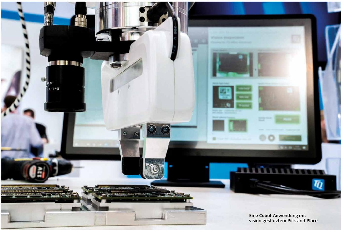
Eine Cobot-Anwendung mit vision-gestütztem Pick-and-Place
