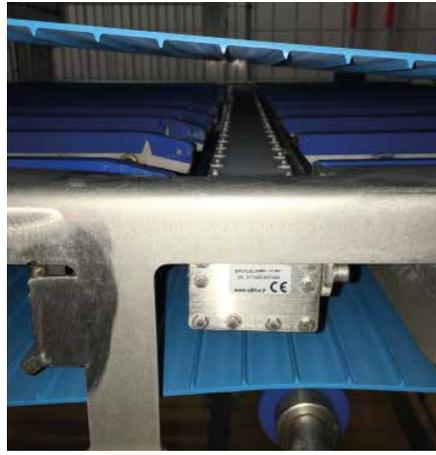
Die Beleuchtung befindet sich unter dem (fürs Foto angehobenen) Transportband.
