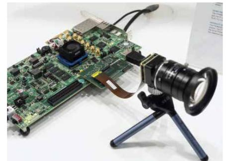
und einer voll integrierten MIPI-Adapterplatine. Damit stehen High-End-Sensoren der Pregius- und Starvis-Serien von Sony, die von Haus aus keine MIPI-Schnittstelle unterstützen, für flexible Embedded-Vision-Designs mit verbreiteten Prozessorboards zur Verfügung. Die preiswerten und einfach zu integrierenden MIPI-Kameramodule sind mit Monochrome- und Color-Sensoren erhältlich und wie alle VC-Kameras industrietauglich und langzeitverfügbar.
