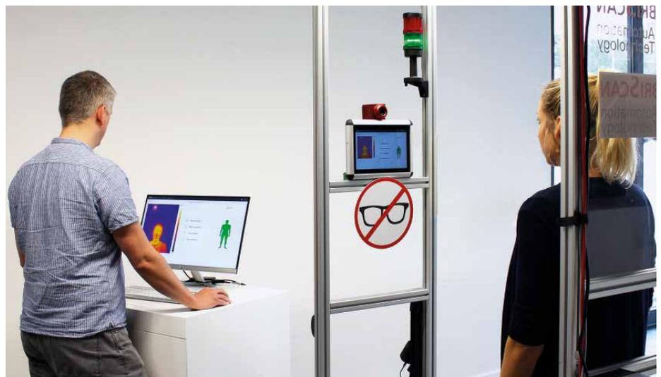
Die Infrarotkamera IRSX-I misst die Körpertemperatur bis auf  $\pm 0,3^\circ\text{C}$  genau.
