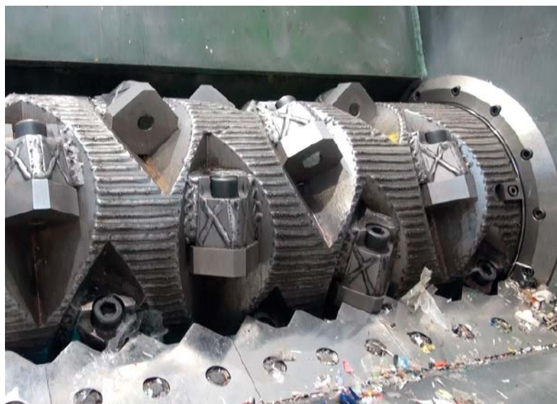
Der Abfall wird von einem hydraulischen Schieber (o.) über ein Schwingensystem gegen den drehenden Rotor (u.) gedrückt. Dieser ist mit speziellen Messern versehen und zerschneidet das Material.
