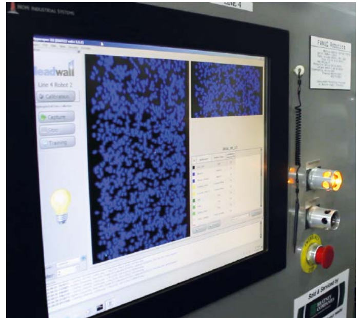
Falschfarbendarstellung der inspizierten Mandeln in der Hyperspektralsoftware für die Datenanalyse.
