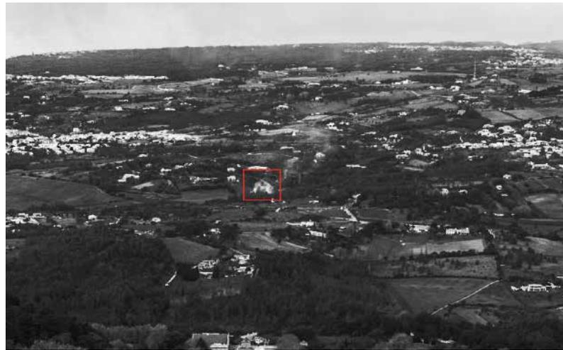
**Noch im Überwachungsturm in Sintra werten ein merkmalsbasierter Algorithmus und eine KI die Bilddaten der Kameras aus und alarmieren im Verdachtsfall innerhalb von rund drei Minuten einen Operator, der dann über das weitere Vorgehen entscheidet.**
