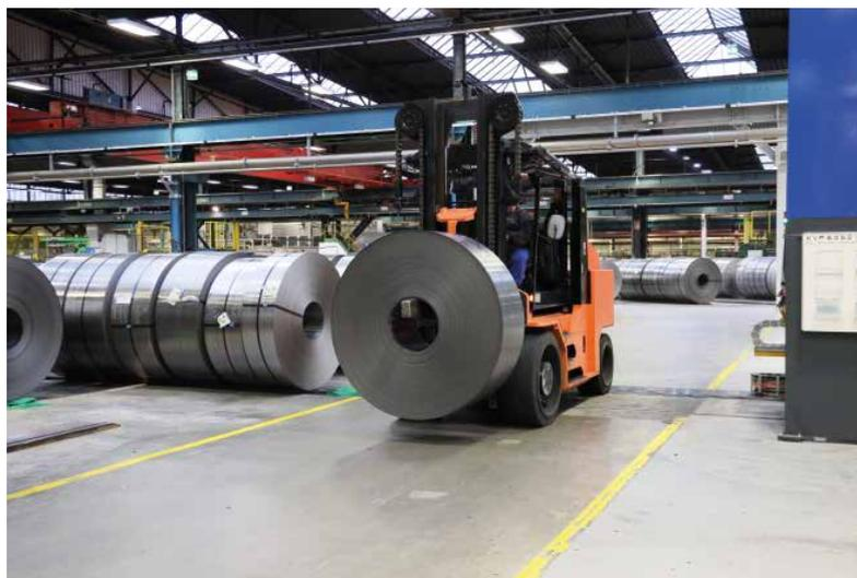
Spezielle Coil-Stapler transportieren tonnenschwere Lasten. Die eingeschränkten Sichtverhältnisse erfordern höchste Konzentration vom Fahrer.
