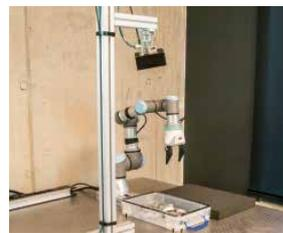
Zudem verringert der in den Systemen enthaltene Sensorkopf Lumiscanx Verdeckungen von Objekten in unübersichtlichen Schüttungen durch sein Kamera-Array.
