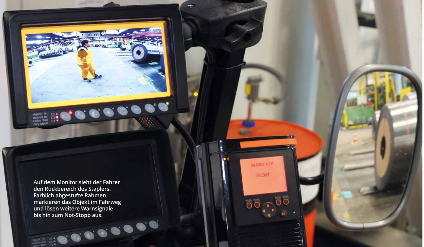
Auf dem Monitor sieht der Fahrer den Rückbereich des Staplers. Farblich abgestufte Rahmen markieren das Objekt im Fahrweg und lösen weitere Warnsignale bis hin zum Not-Stopp aus.
