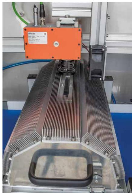
Eine Hyperspektralkamera erstellt kontinuierlich Bilder und gibt sie an die eigens dafür entwickelte Bildverarbeitungs-Software weiter, die diese auswertet.
