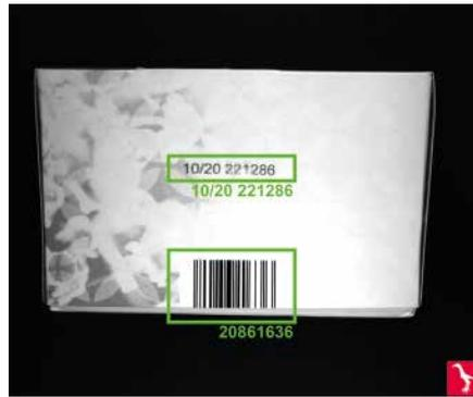
Um Barcode und einer Lotnummer zu prüfen, ist es von Vorteil, wenn lediglich die beiden Prüfmerkmale hervorgehoben sind und die kunstvolle Bedruckung der Verpackung verblasst. Dafür eignet sich eine infrarote Auflicht-Beleuchtung.
