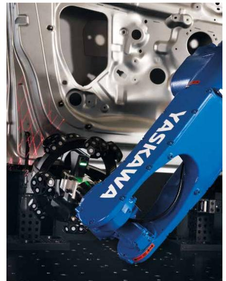
Geführt von einem Motoman GP12, scannt der Messkopf das zu prüfende Bauteil detailliert ab, wobei drei Laser zum Einsatz kommen. Die Messdauer für eine Auto-Seitentür beträgt rund fünf Minuten.
