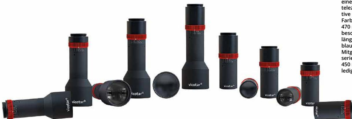
Vision & Control hat eine Reihe einseitig telezentrischer Objektive entwickelt, deren Farbkorrektur schon bei 470 nm eingreift. Dadurch beschränkt sich der Farblängsfehler durch eine blaue Beleuchtung bei den Mitgliedern der Objektivserie TO im Sektor von 450 nm bis 490 nm auf lediglich 10  $\mu\text{m}$ .
