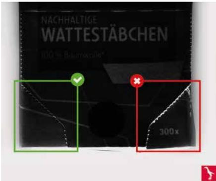
Hier wird die Oberfläche und damit die Perforation der Verpackung geprüft. Eine geeignete Ausleuchtung wird durch Lichtleisten in einer Dunkelfeld-Anordnung realisiert.
