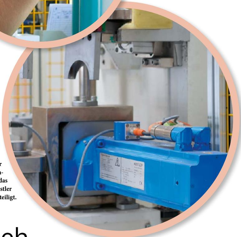
Bei Liuzhou AAM ist an der Fertigung von Antriebskomponenten unter anderem das Fügemodul NCFH von Kistler mit Hohlwellenmotor beteiligt.
