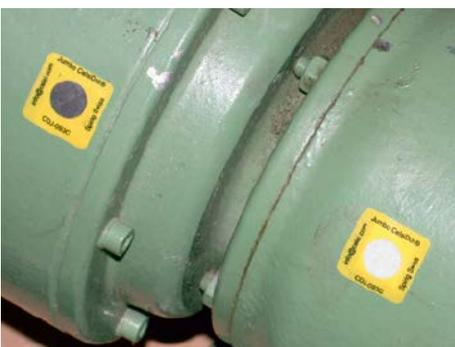
**Jumbo-CelsiDot®** mit Wert 93 °C. Der permanent schwarz verfärbte CDJ, links auf dem Elektromotor, hat irgendwann die 93 °C überschritten. Das angeflanschte Getriebe rechts hat diese 93 °C aber nie erreicht. Garantiefall E-Motor?
