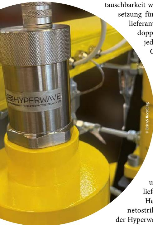
Die magnetostriktiven Linearwegaufnehmer stellen die sichere Klemmung des Filterbandes im automatischen Bandschmelzefilter von BritAS sicher.
