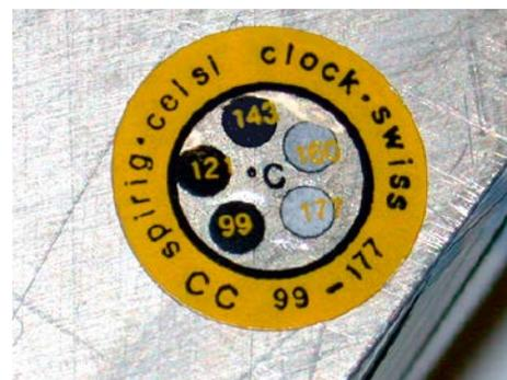
**CelsiClock®** CC mit 5 Temperaturwerten. Dieser Ofen-Beschickungskorb hatte sicher 143°C erreicht, die 160°C aber nicht überschritten. Ein klarer Beweis über die korrekt erfolgte thermische Behandlung der darin eingelegten Teile.
