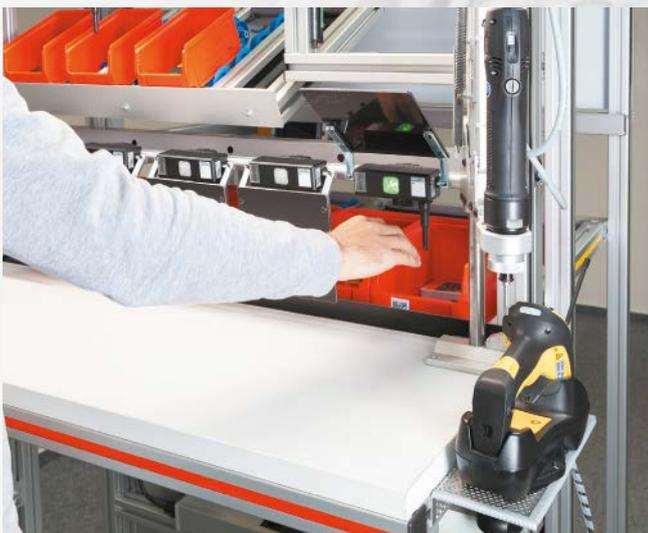
Zusätzlich können Linearachsen aus dem der RK MonoLine- oder der RK DuoLine-Baureihe die sechs Antriebsachsen des Cobots ergänzen und dadurch seinen Bewegungsradius in X- und Z-Richtung vergrößern. Auf diese Weise lassen sich auch mehrere Arbeits- oder Ablageplätze miteinander verknüpfen.
