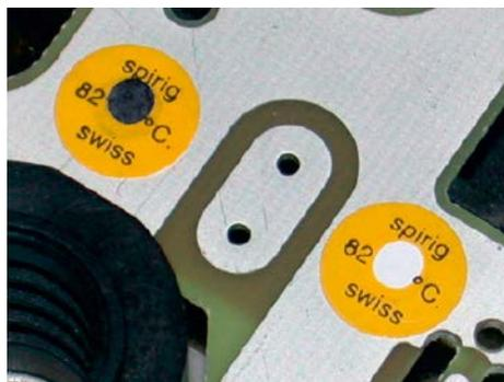
**CelsiPoint®** Auf dem links liegendem CP ist die Temperaturschwelle von 82°C, angezeigt durch Dauerschwärzung des ursprünglich weissen Anzeigefeldes, eindeutig und beweiskräftig überschritten worden. Rechts wurde die 82 °C Schwelle nie erreicht.
