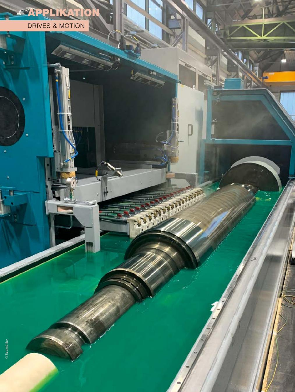
Perfekt muss sie sein, die Oberfläche von Karosserieteilen im Automobilbau. Grundlage sind hochgenau texturierte Walzen, die die Blechteile für die Verarbeitung vorbereiten. Mit Lichtbögen bearbeiten die Texturiermaschinen der Maschinenfabrik Herkules die Walzen hochpräzise. Nun wurden die Maschinen mit Unterstützung eines Nürnberger Antriebsspezialisten auf dezentrale Antriebstechnik umgestellt.
