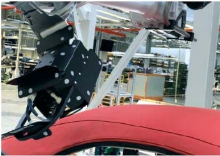
32 Vollautomatische 3D-Inspektionsanlage für Autodächer
