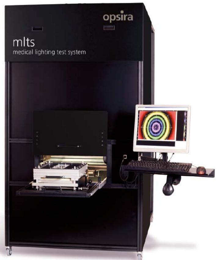
Der Medizinleuchtenprüfstand MLTS von Opsira ermöglicht auf Basis einer photometrisch korrigierten Messkamera das schnelle und hochaufgelöste Messen und Prüfen von Beleuchtungsstärkeverteilungen.
