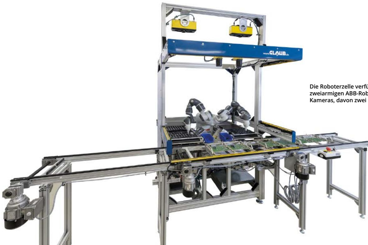
Die Roboterzelle verfügt neben dem zweiarmigen ABB-Roboter über acht Kameras, davon zwei 3D-Kameras.
