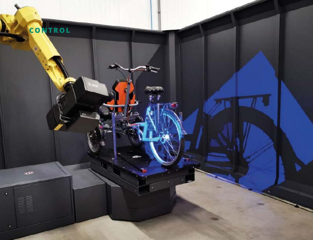
Die vollflächigen Scans ermöglichen dem Fahrradhersteller die 100-Prozent-Inspektion der gefertigten Bauteile, um dann mit gezielten Korrekturmaßnahmen reagieren zu können.
