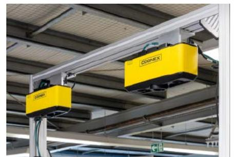
Die 3D-A5060-3D-Kameras von Cognex erfassen die Position der Werkstücke in der Zuführung.
