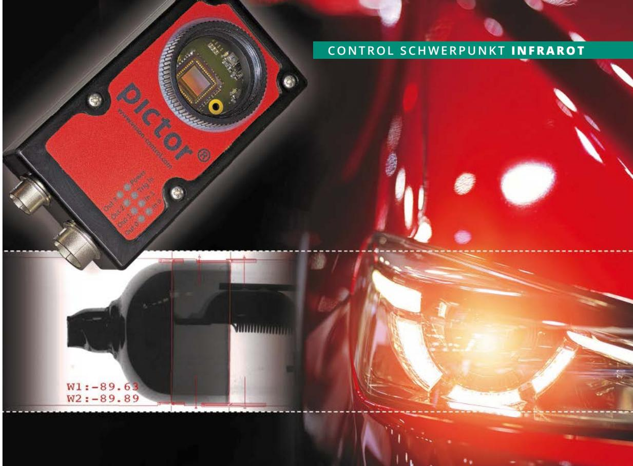
Die Smartkamera Pictor M58/E von Vision & Control durchleuchtet die Autoscheinwerfer, nachdem sie beschichtet wurden, und vermisst die IR-Reflexionsflächen. ►
