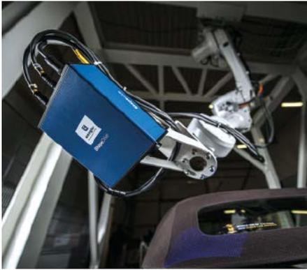
An der Spitze des Roboterarms befindet sich ein 3D-Shapedrive-MLBS-Sensor von Wenglor Sensoric, der 70 Messpositionen in gut zwei Minuten abtastet.
