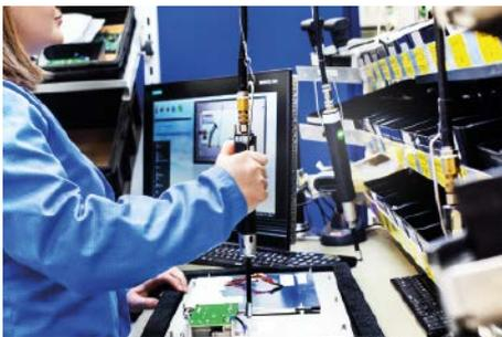
Eine Werkerin montiert eine Leiterplatte mithilfe des Schlaue Klaus'.
