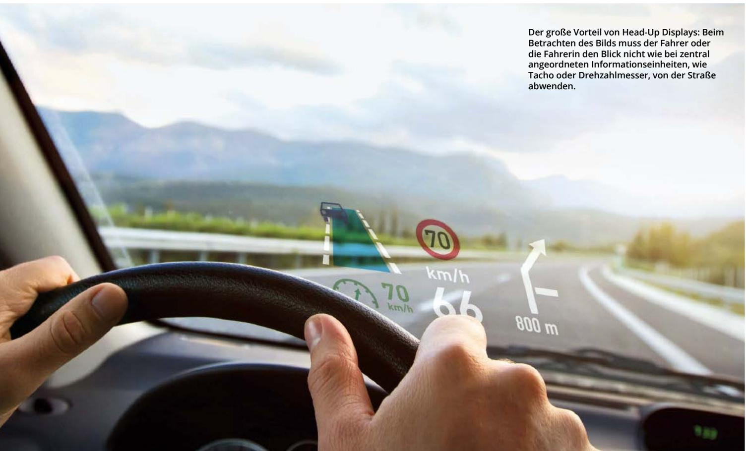
Der große Vorteil von Head-Up Displays: Beim Betrachten des Bilds muss der Fahrer oder die Fahrerin den Blick nicht wie bei zentral angeordneten Informationseinheiten, wie Tacho oder Drehzahlmesser, von der Straße abwenden.
