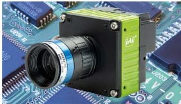
Die SP-25000-CXP4-Modelle enthalten den Gpixel GMAX0505 CMOS Global Shutter Imager mit einer Auflösung von 5.120 x 5.120 Pixel. Die Pixelgröße von 2,5 Mikron führt zu einem optischen 1,1-Zoll-Format, das die Verwendung von C-Mount-Objektiven unterstützt, um zusätzliche Systemersparungen bei Kosten und Größe zu erzielen.
