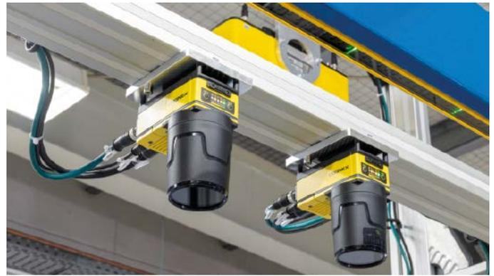
In-Sight Vision-Systeme unterschiedlicher Serien vermessen die Werkstücke sowie die Platine und führen den Greifer.
