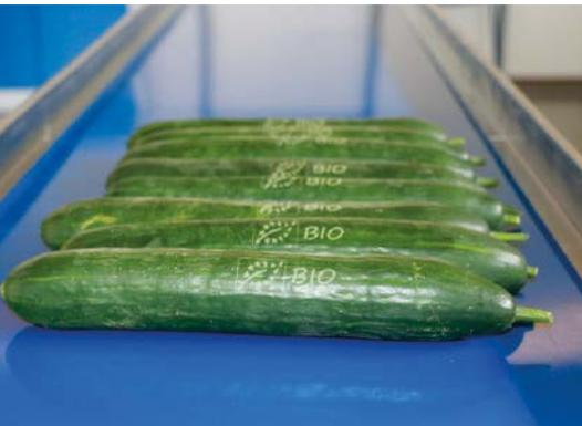
Der Sensor C5-2040CS von Automation Technology vermisst die Gurke für den Laser, der seinen Fokus dann optimal einstellt.
