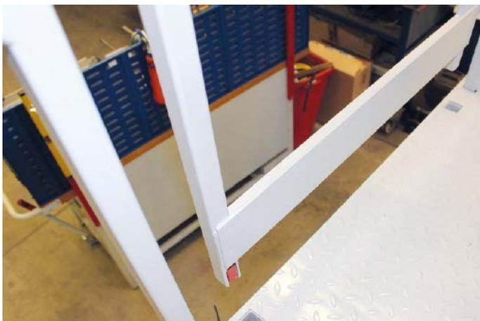
**Angebracht unter der Bühne: Der SRF bietet keine Möglichkeit, die Schutzmaßnahme zu umgehen. Solange die Geländer nicht richtig eingesteckt sind, lässt die Hebebühne sich nicht verfahren ▼**
