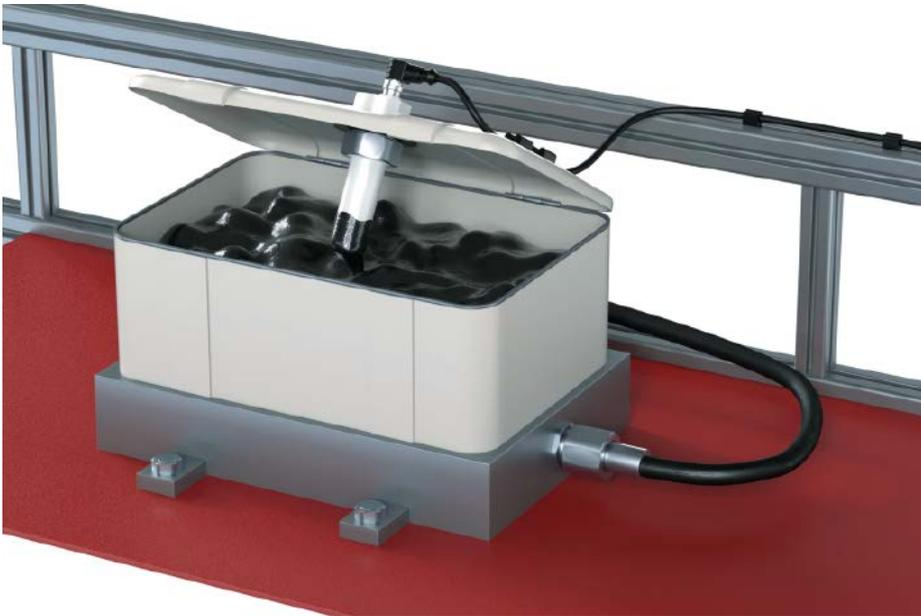
Der kapazitive Sensor FK920420 hat ein kolbenförmiges Teflongehäuse mit sehr gutem Abtropfverhalten. Eine Spezialelektrode bietet eine hohe Feuchtigkeitskompensation. Der anti-elektrostatische sowie säure- und laugenfeste Sensor eignet sich daher zur Überwachung von Behältern mit besonders zähflüssigen Medien.
