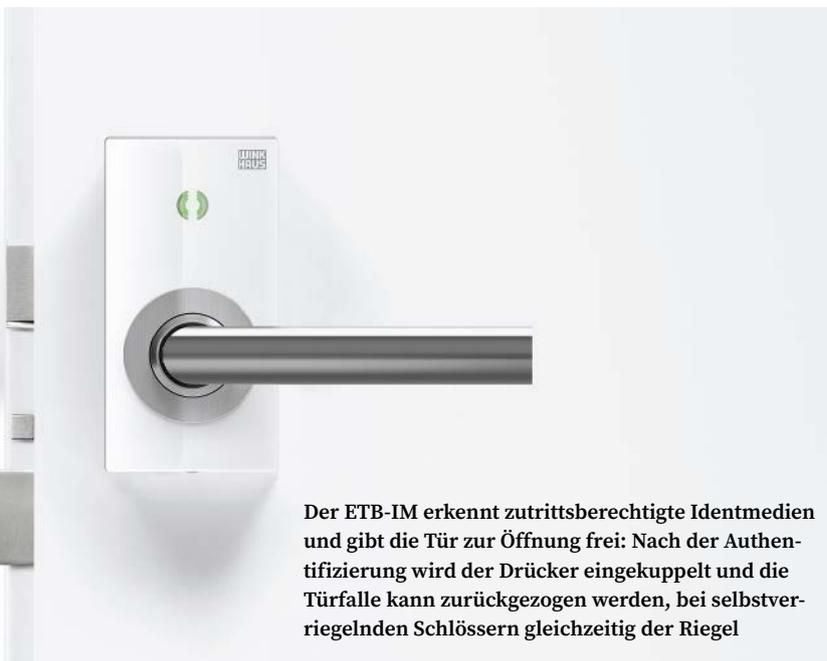
Der ETB-IM erkennt zutrittsberechtigte Identmedien und gibt die Tür zur Öffnung frei: Nach der Authentifizierung wird der Drücker eingekuppelt und die Türfalle kann zurückgezogen werden, bei selbstverriegelnden Schließern gleichzeitig der Riegel
