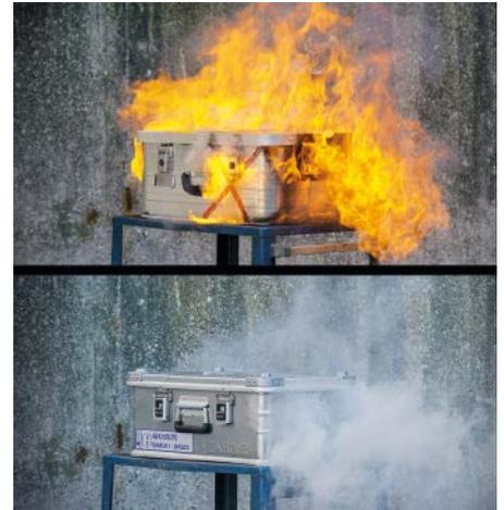
**Beim Thermal Runaway werden u. a. extrem hohe Temperaturen freigesetzt. Der Transport defekter oder kritisch defekter Lithium-Ionen-Batterien ist im Gesetz zur Beförderung gefährlicher Güter geregelt**
