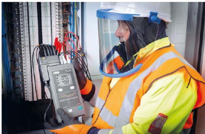
Anschluss des PEL 104 ohne Unterbrechung der Stromversorgung
