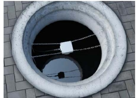
Berührungslose Füllstandkontrolle in einem Frischwasserbrunnen oder einer Zisterne nach dem Echo-Laufzeit-Verfahren mit einem Ultraschallsensor.
