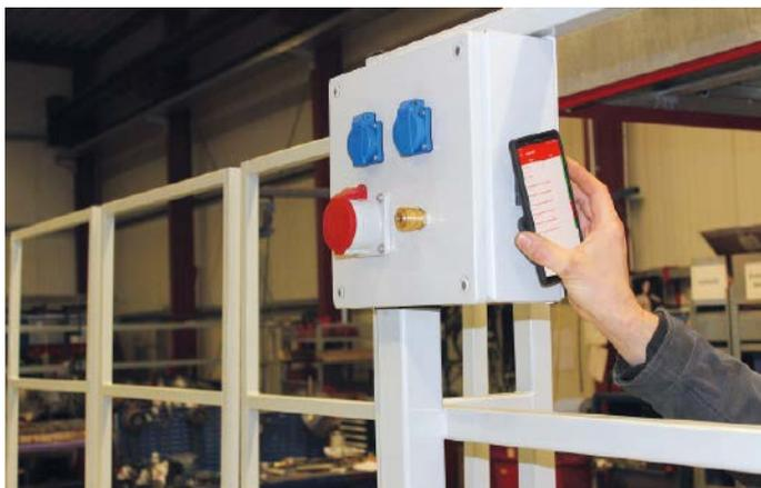
▲ Per NFC-Schnittstelle ist sofort erkennbar, welcher Sensor ein Problem meldet. Der Werker erkennt also, welche Tür oder welches Gelände noch einmal überprüft werden muss, bevor die Hebebühne wieder verfahrbar ist
