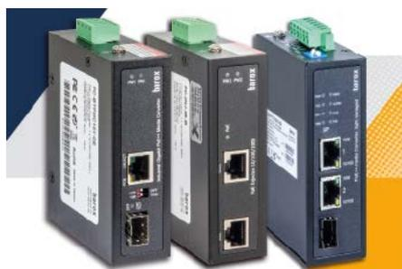
Die neuen, robusten und kompakten Medienkonverter für die DIN-Schienenmontage sind Teil einer hochwertigen und leistungsstarken Produktlinie, die bei einigen Modellen bis zu 90 Watt PoE, PoE+ und PoE++ gemäß IEEE802.3af/at/bt liefern. Durch ihr robustes Industriedesign und den weiten Betriebstemperaturbereich (-40 °C bis +75 °C) eignen sie sich in einem Schrank/Gehäuse für den Einsatz im Außenbereich.
