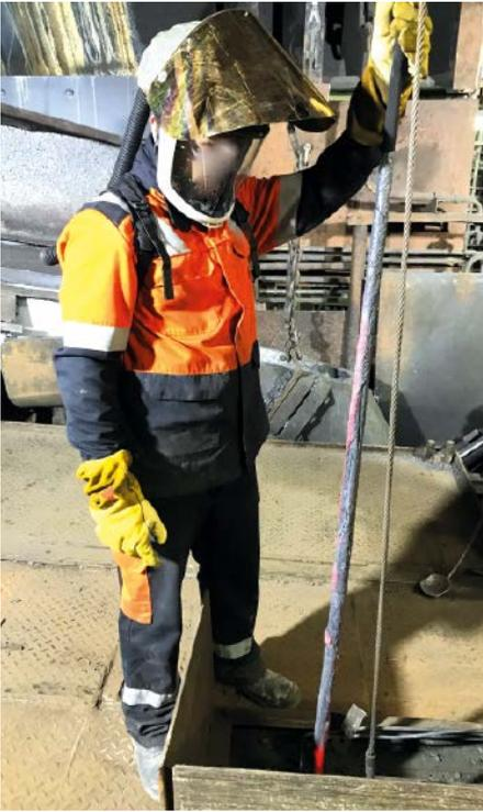
Bisher wurde der Füllstand im Schwebeschmelzofen manuell mit einer Messlanze erfasst.
