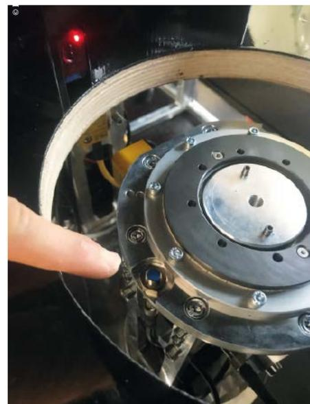
Der Iglidur-Drehkranz PRT-04 verfügt über vorgespannte Gleitelemente. Damit wird über die gesamte Lebensdauer eine haptische Spielfreiheit erreicht.
