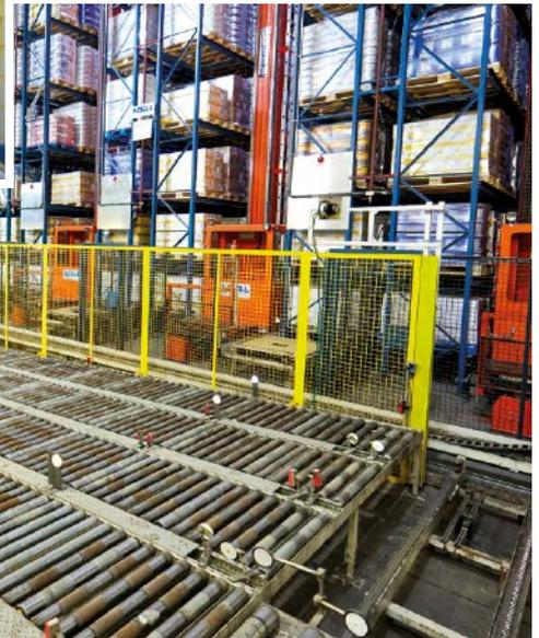
Die Zugangssicherung der fünfspurigen Palettenauslagerung bei Südzucker erfolgt über zwei vertikal ausgerichtete Leuze-Sicherheits-Laserscanner RSL 400. Sie bilden zusammen ein vertikales Schutzfeld, das alle Bahnen abdeckt. ▶
