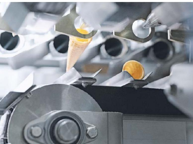
Der Formprozess bei einer typischen Waffel – Beispiel Eistüten: Der Teig wird auf einzelne Backplatten aufgegossen, die mit bis zu 0,5 m/s durch den Ofen zirkulieren. Am Ende des Prozesses wird die Waffel zu einer spitzen Tüte geformt.
