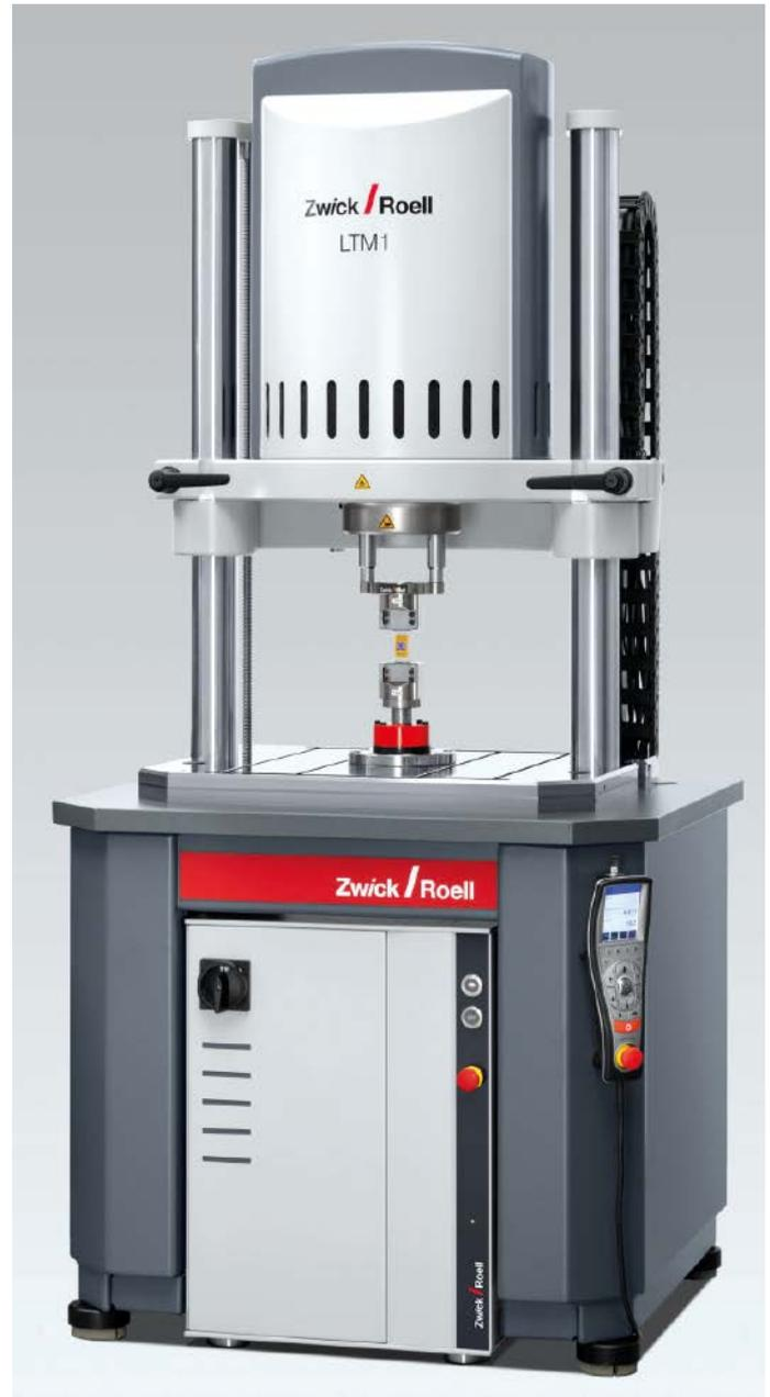
Die Linearprüfmaschine LTM1 bei der Prüfung einer KFZ-Sicherung
