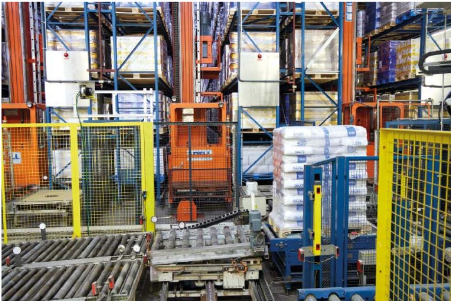
◀ Der 5-spurige Schwerkraftförderer wird von einem Querverförderer mit Paletten beschickt.
