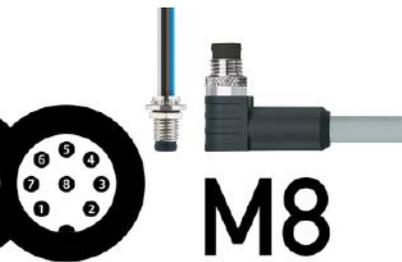
Escha erweitert sein M8-Steckverbinderprogramm um hochpolige Varianten mit acht Pins. Es stehen zwei Leitungsqualitäten zur Auswahl, die sich insbesondere an den Anforderungen der Automatisierungsindustrie orientieren. Die neuen M8-Steckverbinder entsprechen der Norm IEC 61076-2-104. Sie sind staub- und wasserdicht gemäß der Schutzklassen IP65, IP67
