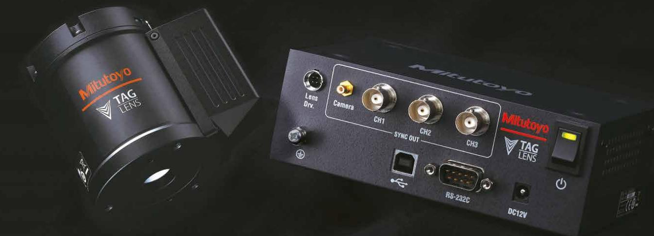
Die Taglens von Mitutoyo ist eine Gradientenlinse, deren Brennweite innerhalb von ca. 7  $\mu\text{s}$  zwischen ihrem positiven und negativen Maximalwert oszilliert. Integriert in ein optisches System führt dies zu einem sich ultra-schnell verschiebenden Fokuspunkt.
