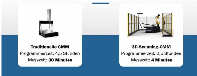
Beim Vergleich der Geschwindigkeiten gewinnt das robotisierte Koordinatenmessgerät gegen das traditionelle mit Leichtigkeit. Allerdings müssen die Voraussetzungen dazu passen: Platzangebot, Erfahrung, Prozesse....
