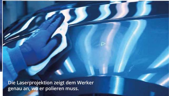
Die Laserprojektion zeigt dem Werker genau an, wo er polieren muss.
