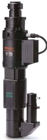
In Verbindung mit der Videomikroskopeinheit VMU-T1 von Mitutoyo steigt die Schärfentiefe, im Vergleich zu einem entsprechenden optischen Aufbau ohne Taglens, um das bis zu 22-fache.
