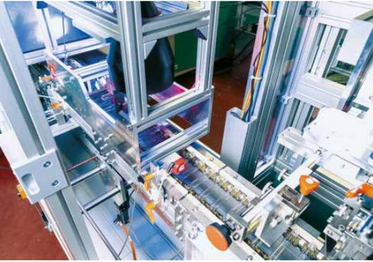
Das Qualitätssicherungssystem Vialchecker ermöglicht es, die Impfstofffläschchen bei hoher Bandgeschwindigkeit zu prüfen.
