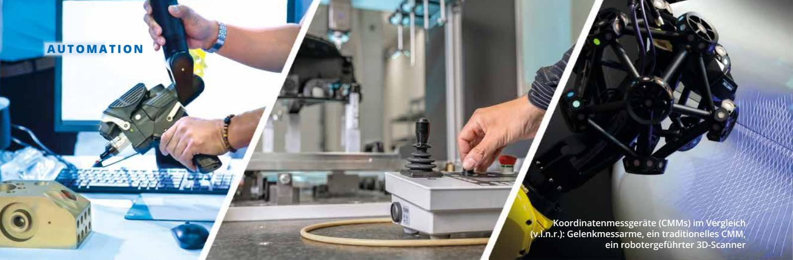
Koordinatenmessgeräte (CMMs) im Vergleich (v.l.n.r.): Gelenkmessarme, ein traditionelles CMM, ein robotergeführter 3D-Scanner
