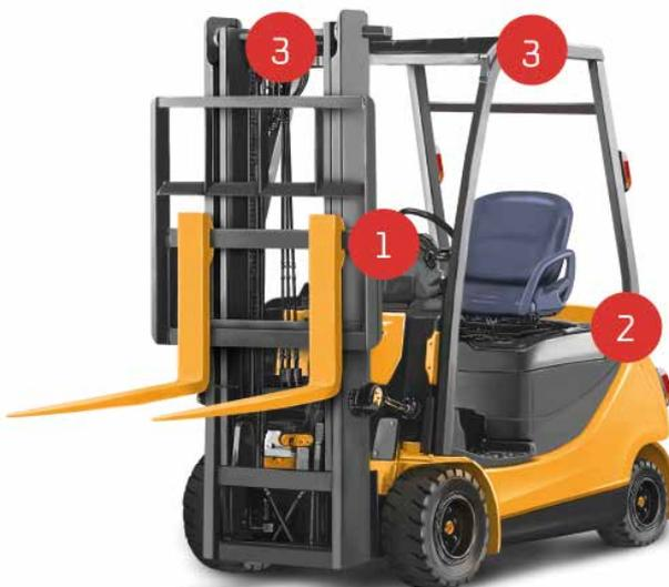
Die Lösung Drivox Security von Xesol besteht im Wesentlichen aus drei Komponenten: D435e-Kameras von Framos, die für die dreidimensionale Wahrnehmung vorne und hinten am Fahrzeug angebracht sind; einem Mikroprozessor für die KI-basierte Bildauswertung sowie einem Display.
