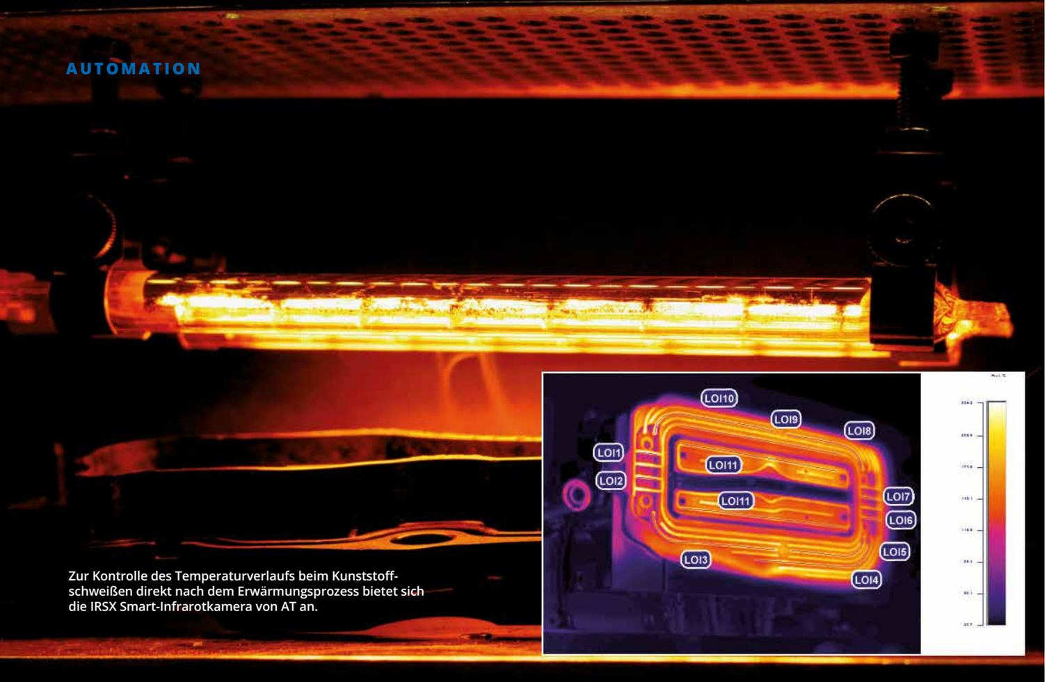
Zur Kontrolle des Temperaturverlaufs beim Kunststoffschweißen direkt nach dem Erwärmungsprozess bietet sich die IRSX Smart-Infrarotkamera von AT an.
