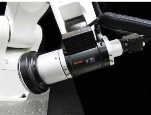
Der erweiterte Schärfentiefbereich der Taglens ermöglicht die Integration einer Mikroskopeinheit für Inspektionsaufgaben in ein Robotersystem, wie es in dem Projekt Robotag realisiert wurde.
