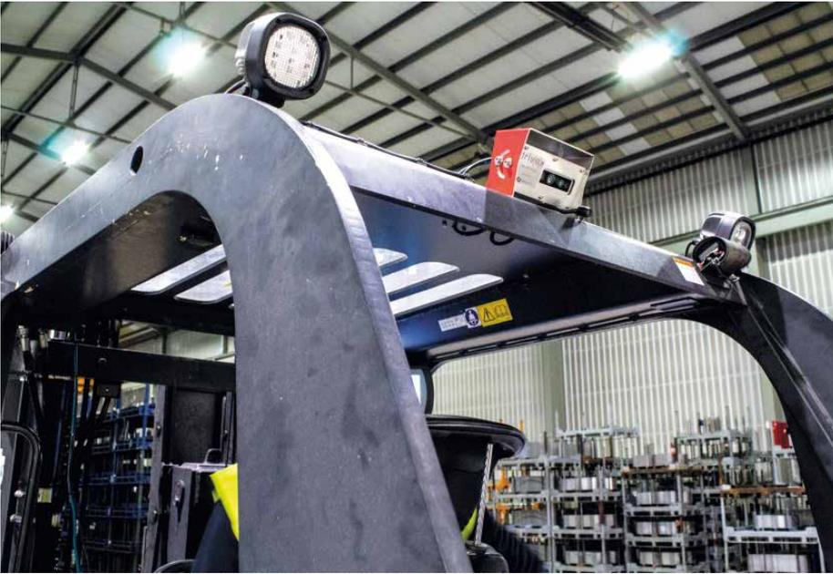
Die Kamera ermöglicht in der DrivoX-Security-Lösung von Xesol die vollständige Sicht auf Fußgänger und Objekte, die vom Gabelstapler 1 bis 8 m weit entfernt sind.
