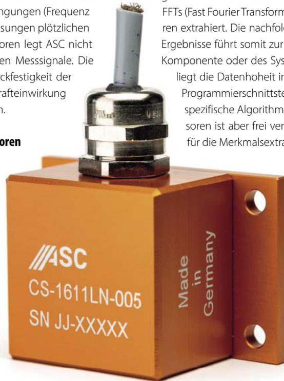
**Der triaxiale kapazitive Beschleunigungssensor ASC CS-1611LN überträgt seine Signale verlustfrei über lange Entfernungen.**
