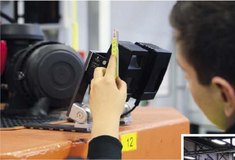
Um das System einzurichten, muss der Anwender lediglich einmalig Höhe und Neigungswinkel der Kamera sowie die Fahrzeugbreite messen und in der Steuerung eingeben.
