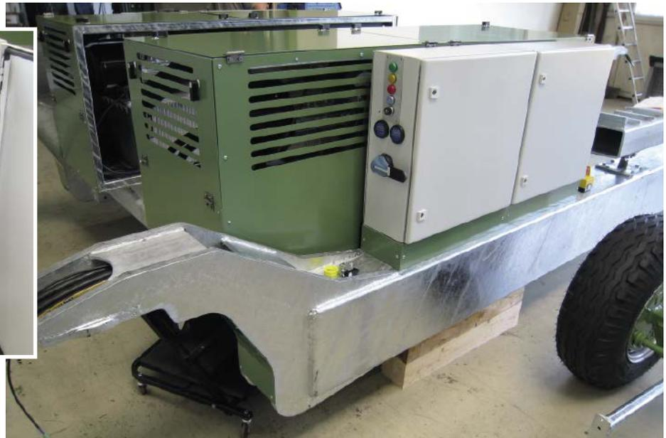
Der Schaltschrank mit den jeweils notwendigen Automatisierungskomponenten befindet sich an der Seite des Trailers.
