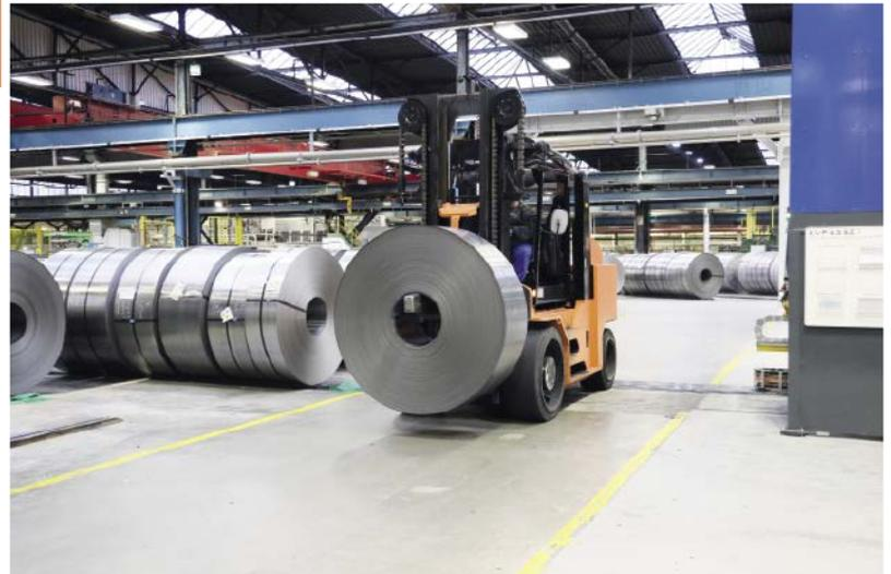
Spezielle Coil-Stapler transportieren tonnenschwere Lasten. Die eingeschränkten Sichtverhältnisse erfordern höchste Konzentration vom Fahrer.
