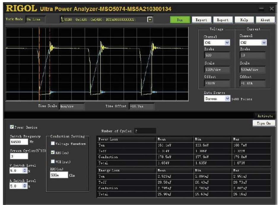
Abb. 4: Vermessung des Schaltvorgangs mit der UPA-PC-Software
