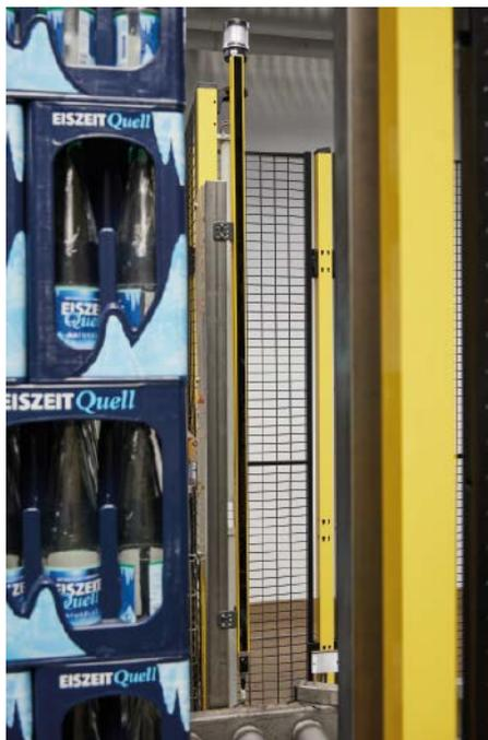
Die Lichtvorhänge MLC 530 SPG gewährleisten die Sicherheit beim Be- und Entladen von Paletten.
