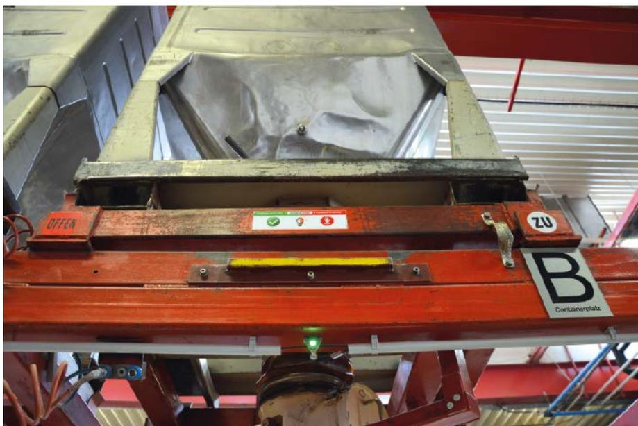
Statt einer aufwendigen Signalleuchte setzt der Gewürzspezialist Kotányi auf kompakte Bicolor-LED-Leuchten zur Kennzeichnung von Rohmaterialbehältern über einer Abfüllstation.
