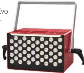
Bei einer Anschlussleistung von 1.150 W bewerkstelligen die 48 LEDs eine Lichtstromausgabe von 120.000 Lumen im Standardmodus und können im Blitzmodus auf bis zu 260.000 Lumen gesteigert werden. Alles bei gleichbleibender Energieaufnahme und im Dauerbetrieb abrufbar.
