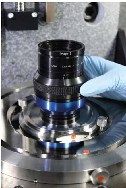
MTF-Messung am neuen HR-Objektiv im Rahmen der Qualitätssicherung bei Qioptiq
