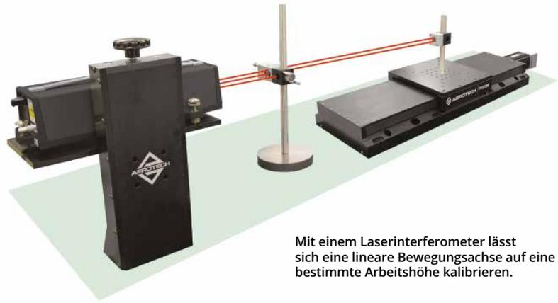
Mit einem Laserinterferometer lässt sich eine lineare Bewegungsachse auf eine bestimmte Arbeitshöhe kalibrieren.
