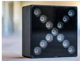
punkten und ermöglicht somit den Griff auch in nicht sortenreine Kisten und für bisher kaum automatisierbare, komplexe Werkstücke. Hierbei entstehen durch den Lichtfeld-basierten Multi-Kamera-Ansatz ebenfalls weniger Verdeckungen und auch bei steigender Entfernung bleibt eine hohe Tiefenschärfe erhalten.
