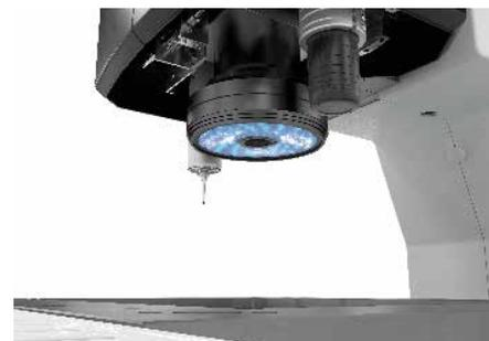
Das Beste aus zwei Welten vereint die O-Inspect in einem Gerät: Das optische Messgerät mit taktilem Sensor ermöglicht es, Bauteile optisch und auch taktil zu messen, wodurch Anwender auf ein erneutes Einmessen beim Wechsel des Sensors verzichten können.
