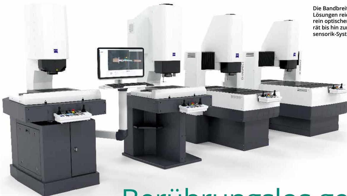
Die Bandbreite an Lösungen reicht vom rein optischen Messgerät bis hin zum Multisensorik-System.
