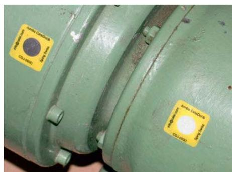
**Jumbo-CelsiDot®** Mit 93 °C Schwelle. Der links auf dem Elektromotor permanent schwarz verfärbte CDJ hat irgendwann die 93 °C überschritten. Das angeflanschte Getriebe rechts hat diese 93 °C aber nie erreicht. Garantiefall gekärt? Sonderanfertigungen auf Anfrage m möglich.
