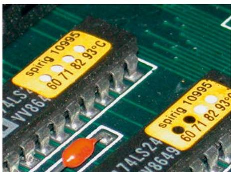
**Micro-CelsiStrip®** Im rechts liegendem Micro-CS (MCS) sind die ursprünglich weissen 60°C & 71 °C Felder permanent schwarz verfärbt, also in der Vergangenheit mindestens 1x deren Wert überschritten worden. Die 82 °C und höher wurden nie erreicht.
