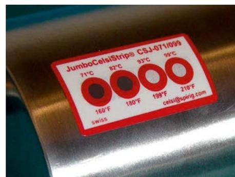
**Jumbo-CelsiStrip®** In der Lebensmittelverarbeitung müssen Rohrleitungen regelmässig mit genügend heisser Spülflüssigkeit gereinigt und entkeimt werden. Verteilt platzierte CSJ dokumentieren, ob an allen Stellen die unbedingt notwendige Minimaltemperatur auch erreicht wurde. Die Grösse der Jumbo's erlaubt auf Distanz eine Ablesung etwa an Hochspannungsschaltanlagen.
