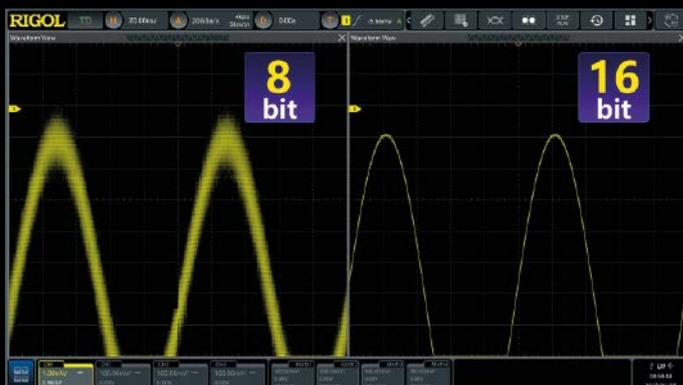
16 Bit vertikale Auflösung mit dem Rigol-Oszilloskop der Serie DS70000
