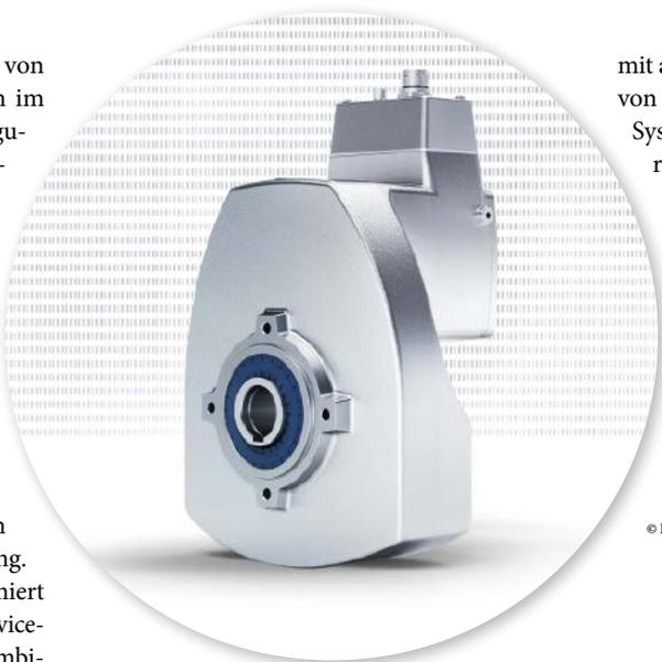
Die erste verfügbare DuoDrive-Baugröße deckt Getriebeübersetzungen von  $i=3,24$  bis  $i=16,2$  ab und ist für den Drehmomentbereich bis 80 Nm und Drehzahlen bis  $1.000 \text{ min}^{-1}$  ausgelegt.
