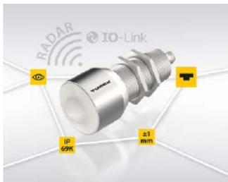
Turck stellt Radarsensoren zur Abstandsmessung bis 15 Meter für raue Einsatzbereiche in der Fabrikautomation sowie in Outdoor- oder mobilen Anwendungen vor. Die 122-GHz-Geräte in Schutzart IP67/69K sind schockbeständig bis 100 g und eignen sich daher beispielsweise zur Distanzmessung in der
