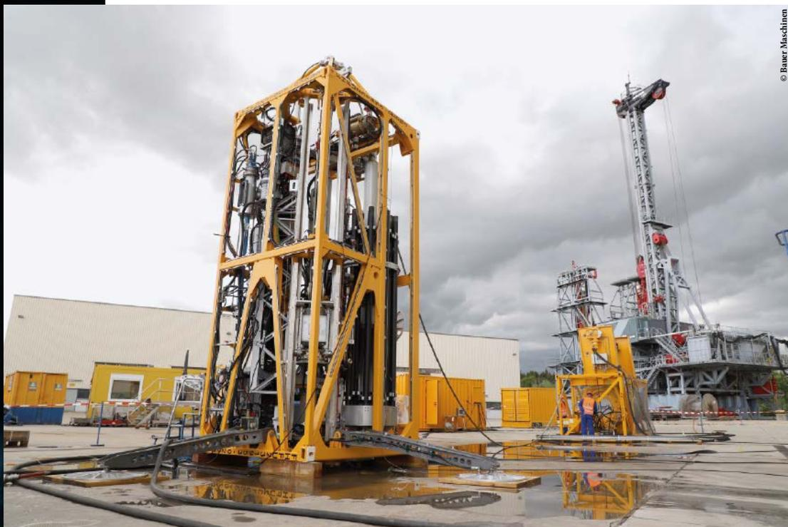
Das Meereserkundungsgerät MeBo 200 bohrt in bis zu 2.500 Metern Tiefe bis zu 200 Meter tief in den Meeresboden.
