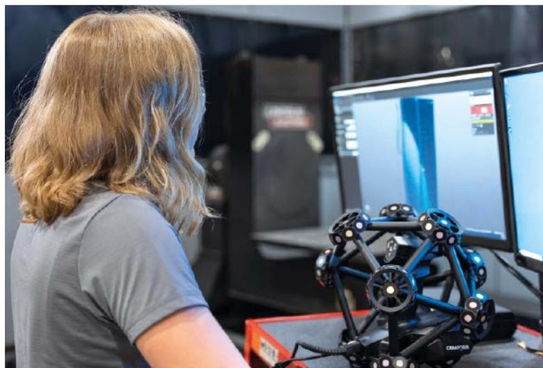
Eine Mitarbeiterin von Lincoln Electric Additive Solutions prüft die Scan-Daten des Creaform Metrascan 3D, die sie von einem 3D-gedruckten Metallteil erstellt hat.
