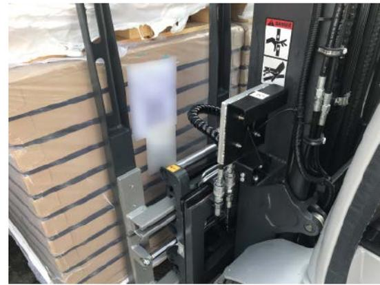
Der RFID-Tag am Ladungsträger trägt Informationen über Inhalt, Referenz oder Empfänger.
