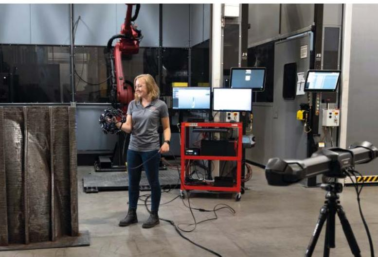
Lincoln Electric Additive Solutions entschied sich für 3D-Messtechnik von Creaform – genauer: für den Metrascan 3D –, um 3D-Oberflächenmodelle von seinen 3D-gedruckten Metallteilen zu erstellen und sie mit dem ursprünglichen CAD zu vergleichen.
