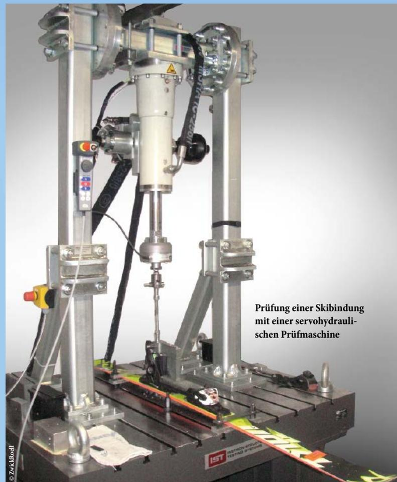
Prüfung einer Skibindung mit einer servohydraulischen Prüfmaschine
