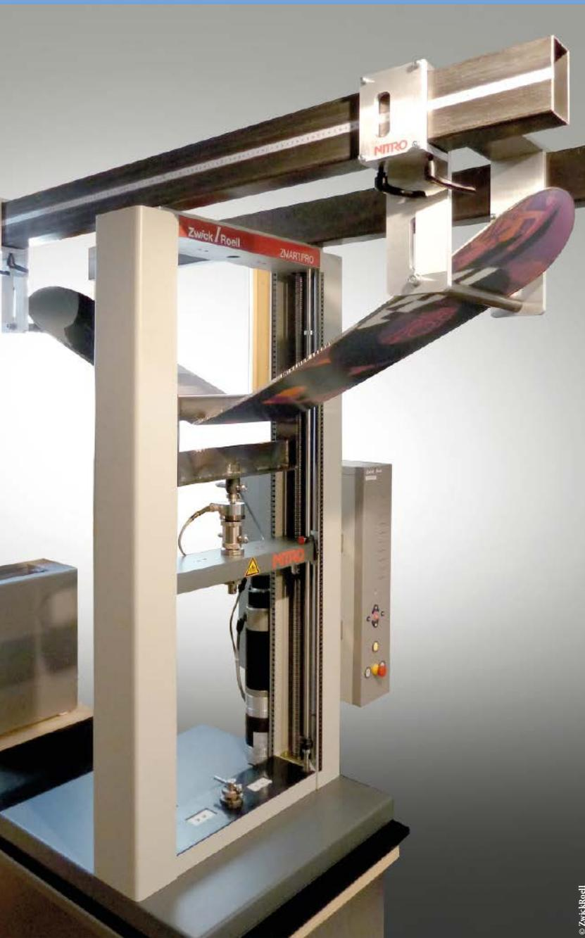
Sportgeräte müssen nach vorgegebenen Kriterien geprüft werden, um technische Vorgaben einzuhalten und die Sicherheit zu gewährleisten. Nitro Snowboards prüft seine Boards in einem 3-Punkt-Biegeversuch mit einer Prüfmaschine mit maximalen Prüfkraften von 5 bis 250 kN und Marker setzt bei seinen Ski-Bindungssystemen auf servohydraulische Prüfsysteme.
