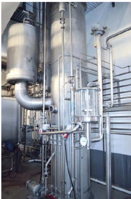
Corosys hat die Entalkoholisierungsanlage und den zugehörigen Schaltschrank mit aktuellen Automatisierungskomponenten ausgestattet.
