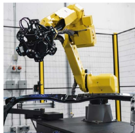
Robotergeführter optischer KMG-Scanner bei der Qualitätskontrolle eines Fahrgestells. ►
