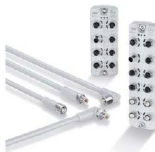
Die IO-Link-Master der Serie Performanceline sind speziell für die Lebensmittelindustrie konzipiert. Sie erfüllen die Schutzarten IP65, IP67 und IP69K, die M12-Buchsen bestehen aus Edelstahl und die Dichtungen aus EPDM. Die neuen IO-Link-Master haben entweder vier oder acht Ports
