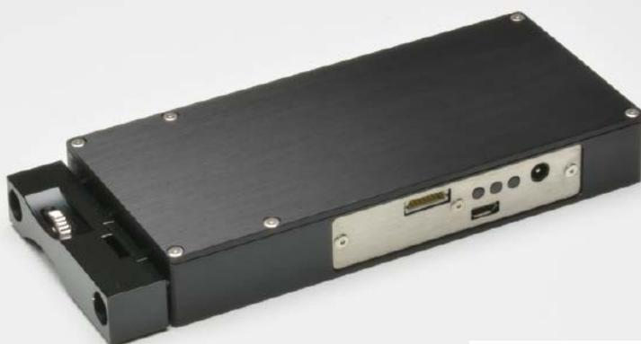
Das Mini-Spektrometermodul C15471 beinhaltet optische Elemente, Bildsensor und Probenhalter in einem Gehäuse und ist damit vielseitig einsetzbar.
