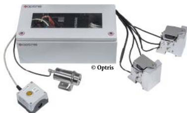
Optris hat ein neues Bottom-up-Glasinspektionssystem entwickelt. Durch die Installation von zwei Infrarotkameras unterhalb der Vorspannlinie messen sie die Temperatur immer auf der nicht beschichteten Seite des Glases mit hohem Emissionsvermögen (1.600 Pixeln Scanzeilenauflösung
