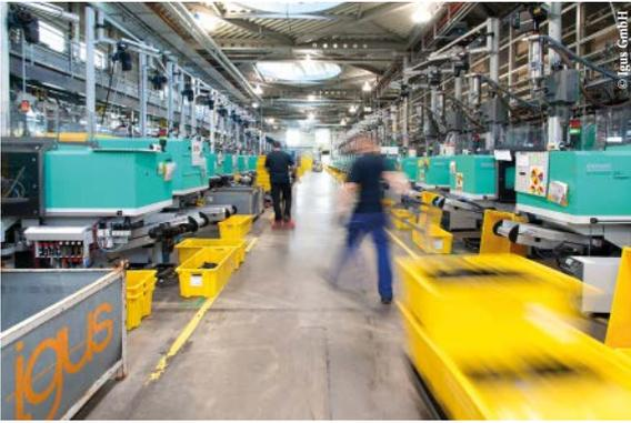
**Insgesamt 500 neue Spritzgussmaschinen werden bei Igus in Köln aufgestellt, 100 ältere Spritzgussmaschinen wurden gegen 40 Prozent energieeffizientere getauscht. Im Jahr 2025 soll die Produktion klimaneutral sein, Stand heute sind es 95 Prozent.**
