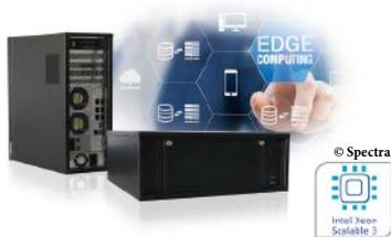
Der Embedded Server Powerbox 4000AC C621A von Spectra eignet sich für Anwendungen im Bereich der industriellen Bildverarbeitung. Unterstützt wird die Datenverarbeitung durch 32GB RAM
