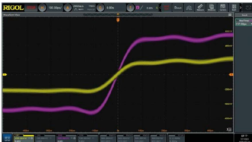
Abb. 2: Messung der Anstiegszeit: Pink: via HF-Tastkopf PVA8700 von Rigol, Gelb: via Koaxialkabel (BNC-Anschluss)
