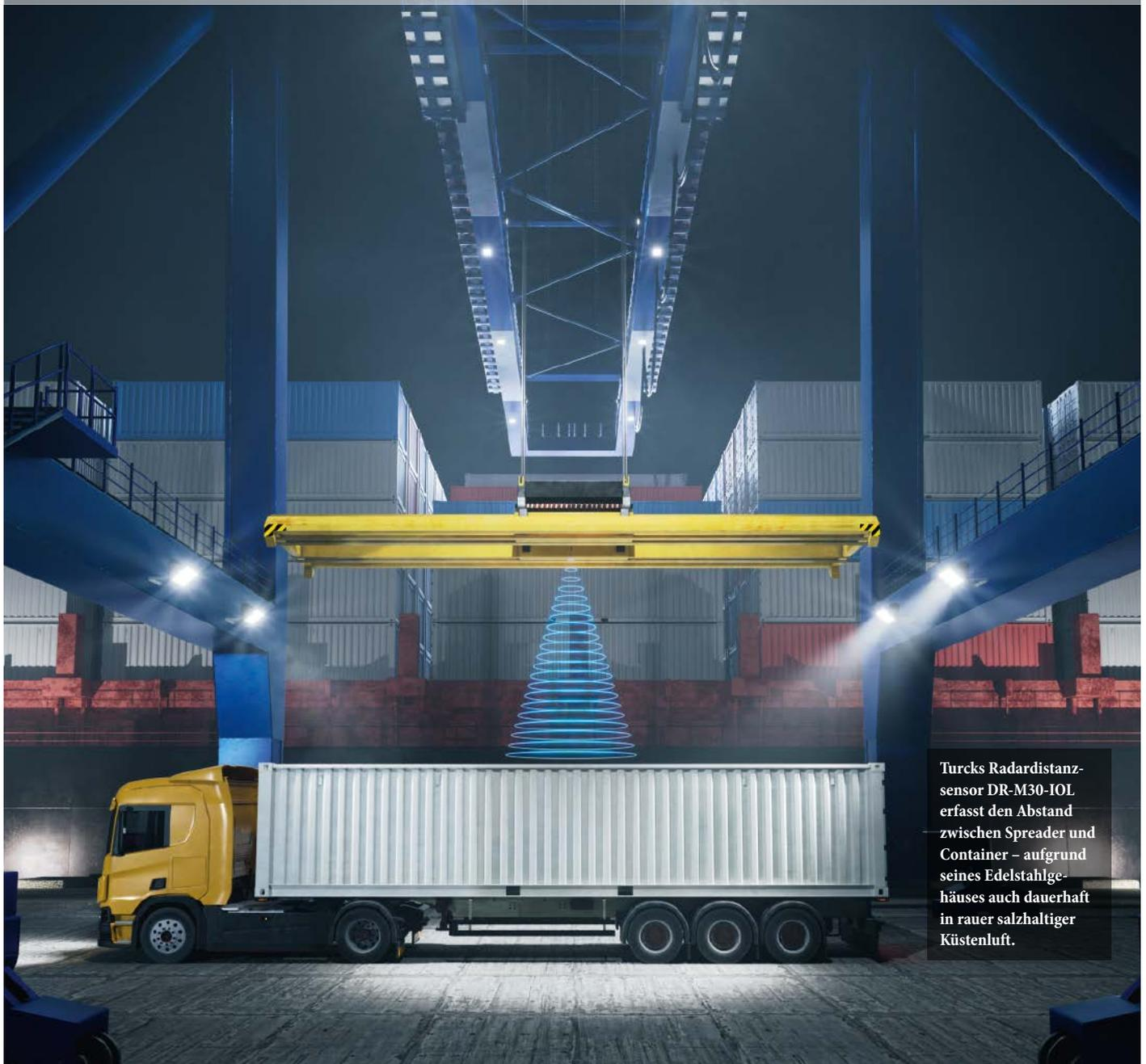
Turcks Radardistanzsensor DR-M30-IOL erfasst den Abstand zwischen Spreader und Container – aufgrund seines Edelstahlgehäuses auch dauerhaft in rauer salzhaltiger Küstenluft.
