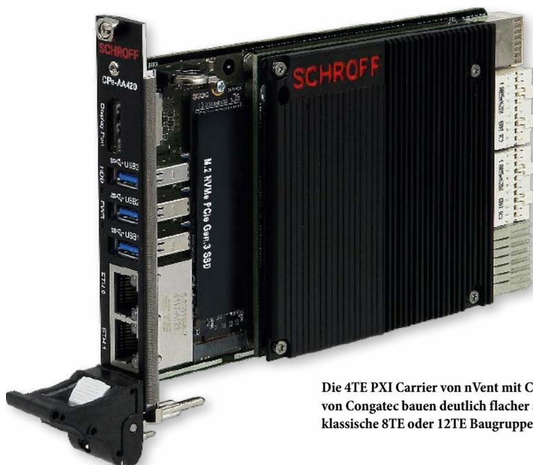
Die 4TE PXI Carrier von nVent mit COMs von Congatec bauen deutlich flacher als klassische 8TE oder 12TE Baugruppen.
