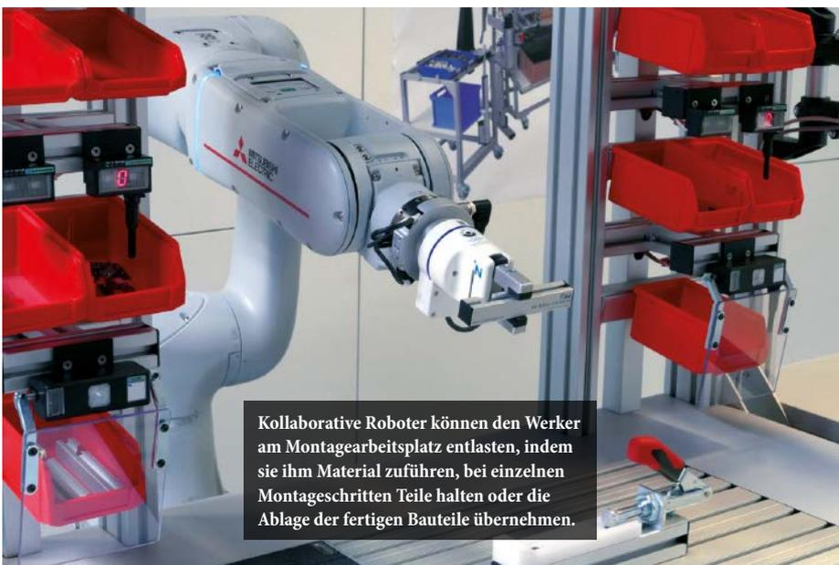
Kollaborative Roboter können den Werker am Montagearbeitsplatz entlasten, indem sie ihm Material zuführen, bei einzelnen Montageschritten Teile halten oder die Ablage der fertigen Bauteile übernehmen.
