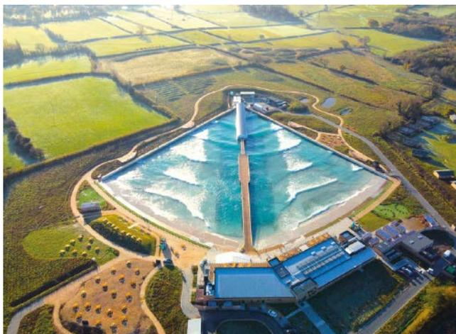
The Wave Bristol: Jede Surflagune vom Typ Wavegarden Cove besteht aus einem fächerförmigen See, der mittig von einer Brücke mit der Anlage zur Wellengenerierung geteilt ist.
