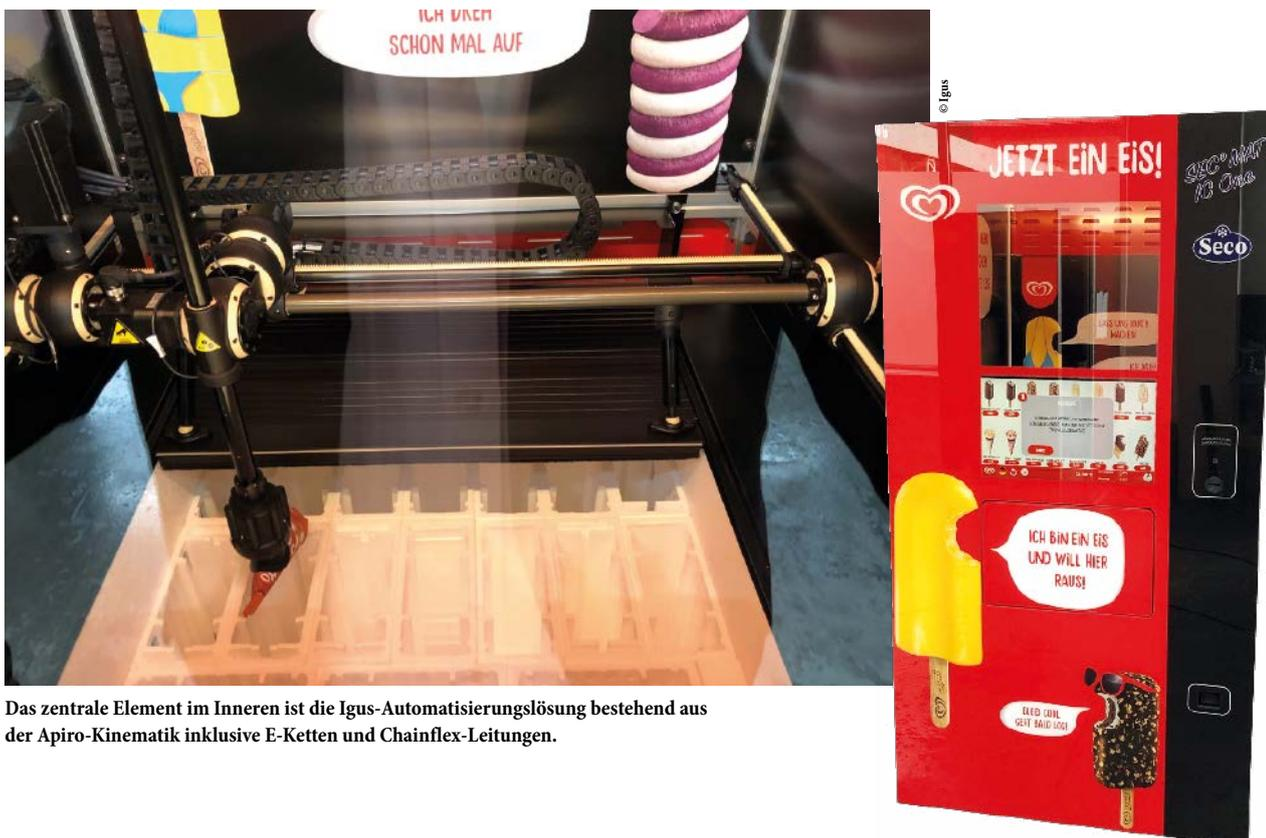
Das zentrale Element im Inneren ist die IguS-Automatisierungslösung bestehend aus der Apiro-Kinematik inklusive E-Ketten und Chainflex-Leitungen.
