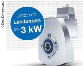
Das Duodrive von Nord Drivesystems ist ein integriertes Getriebemotorkonzept im hygienischen Wash-down-Design und deckt jetzt einen Leistungsbereich bis 3 kW ab. Das System integriert den Synchronmotor IE5+ in ein einstufiges Stirnradgetriebe und erreicht so bis zu 92 Prozent Wirkungsgrad. Auch im Teillastbetrieb wird eine hohe Systemeffizienz erzielt. Das konstante Motordrehmoment über einen weiten Drehzahlbereich ermöglicht eine konsequente Variantenreduzierung und Betriebskostensenkung. Das
