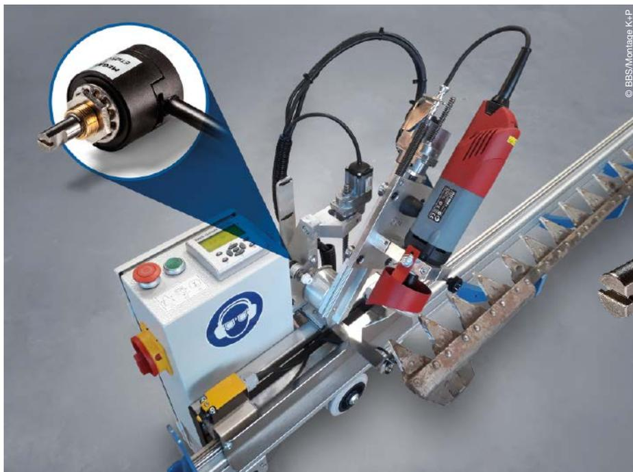
Der ET1-Drehgeber „dirigiert“ das Messerschärfgerät an die richtige Position am Mähbalken.
