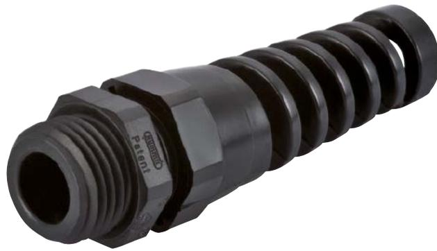
Die Kabelverschraubungen HSK-K-Flex mit Knickschutz sind aus Polyamid zertifiziert, nach UL f1 gefertigt und in Schutzart IP 68 – 10 bar/ IP 69 K mit zusätzlichem O-Ring ausgeführt.
