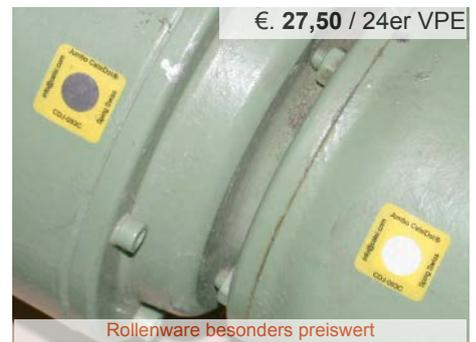
Diese beiden **Jumbo-CelsiDot®** (= CDJ) 93°C Etiketten sind links auf einem E-Motor und rechts auf einer Getriebebox platziert. Motorgehäuse hat die 93°C überschritten, das Getriebe nicht. Die grosse weisse Fläche kann auch auf Distanz optisch gut erkannt werden. Standardmässig verfügbar in 54°C, 93°C und 121 °C.
