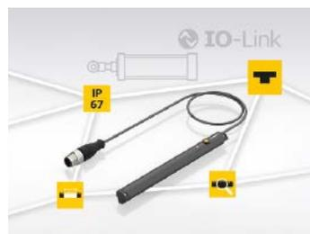
Mit der WIM-IOL-Serie ergänzt Turck sein Angebot an kompakten Positionssensoren zur Erfassung magnetischer Kolben in Pneumatik- oder Hydraulikzylindern. Die Serie besteht aus acht Sensoren mit IO-Link 1.1, die Messbereiche von 32 mm bis 256 mm abdecken. Über IO-Link und den integrierten Taster
