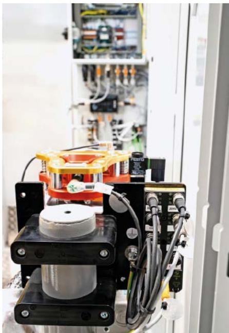
Die Signale der Schweißkappenfräser bringt ein I/O-Hub TBIL zum IO-Link-Master (im Hintergrund).
