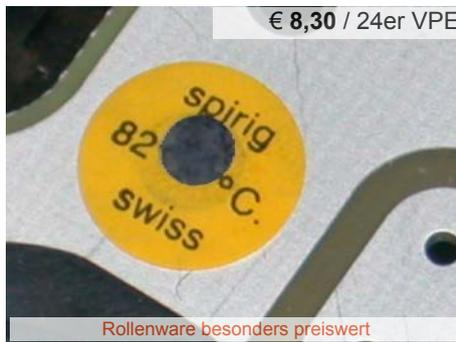
Dieser **CelsiPoint®** (= CP) ist in (40) verschiedenen T-Werten lieferbar. Bei einem Heissluft-Trocknungsprozess hat dieser Teil eines Prints die 82°C sicher überschritten, aber um Wieviel?
