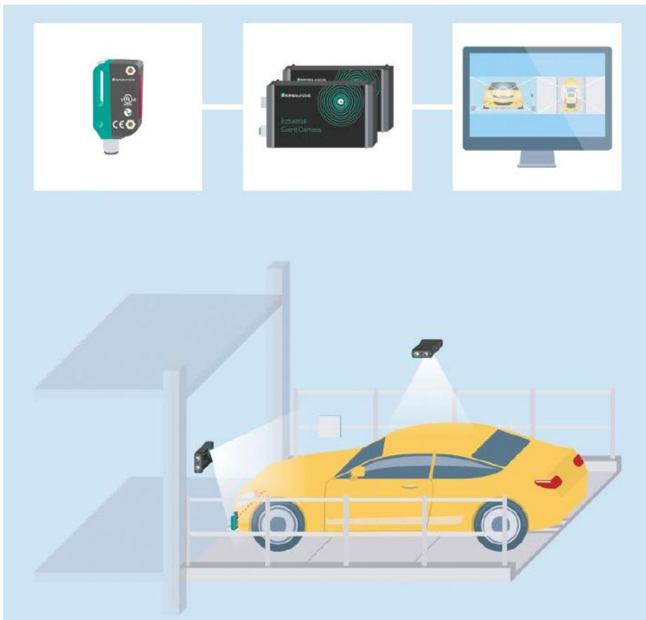
Die industrielle Ereigniskamera VOC dokumentiert in einem automatischen Parkhaus jeden Einparkvorgang.
