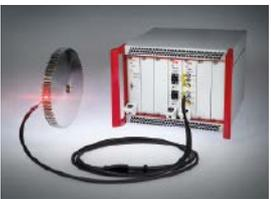
Der Laser-Tachometer Ifta LMM2 (Laser Measurement Module) ist ein faseroptischer Sensor, der in Kombination mit einem Ifta-Messsystem zur berührungslosen Messung von Drehzahl, Winkelgeschwindigkeit und Schwingwinkel an Rotoren und Wellen eingesetzt werden kann. Das auf optischer Reflexion beruhende Messprinzip erfolgt mit Hilfe eines an der drehenden Welle befestigten Zahnradgebers oder
