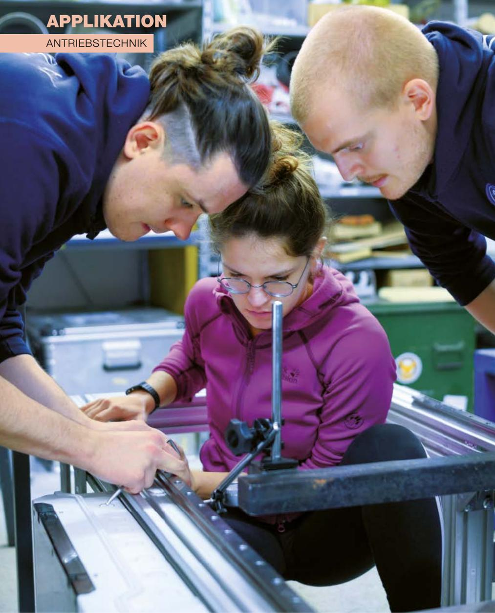
Ziel des Projektes Cryosphere der WARR Raketentechnik ist es, eine Hybridrakete mit einem kryogenen Motor zu entwickeln. Derzeit wird das Versorgungssystem der Brennkammer getestet. Dabei helfen Profilschienen und Präzisionslaufwagen, die sich unter anderem durch ihre hohe Steifigkeit für diese besondere Anwendung eignen.
