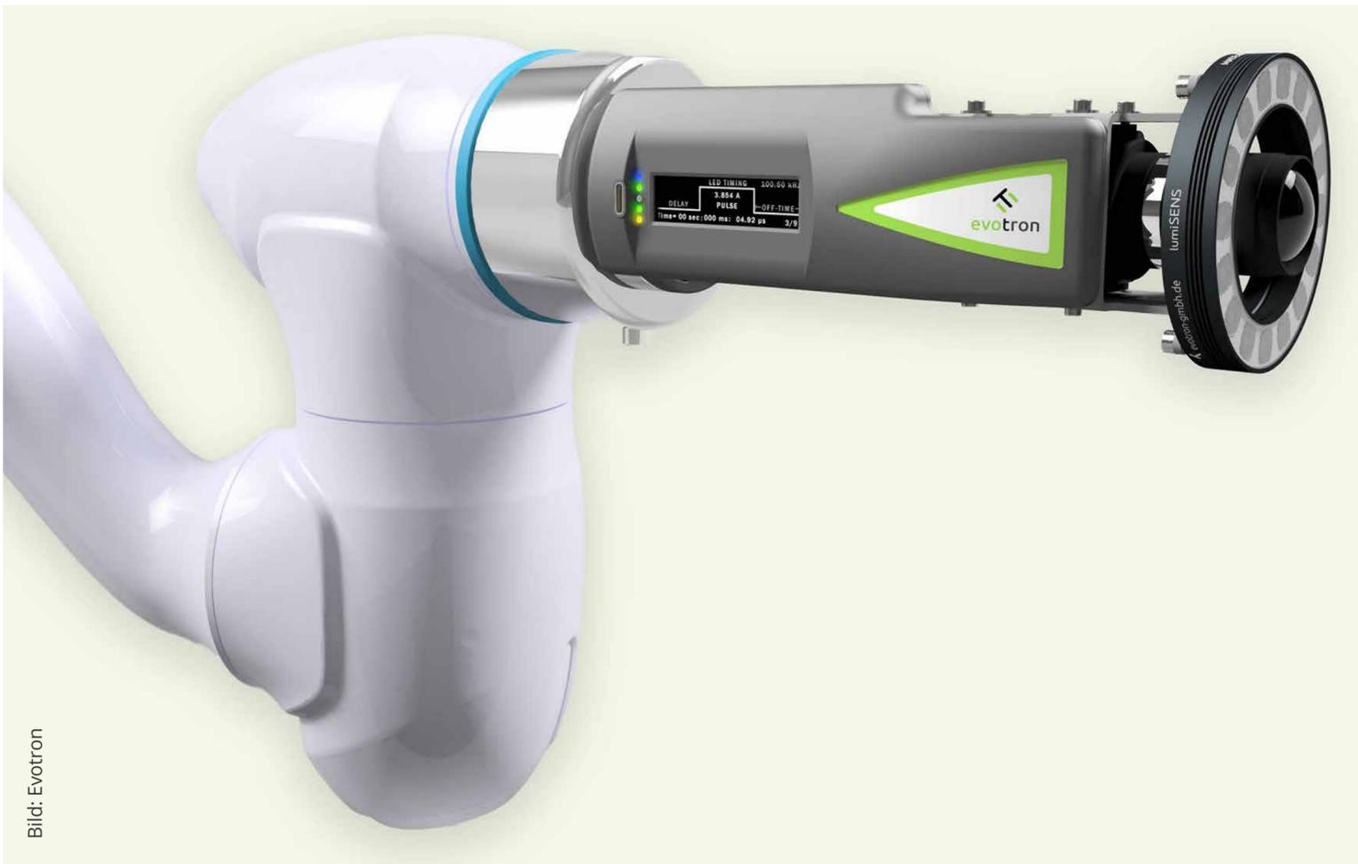
Das neue Software-Tool Robot Image Capture RCAM von Evotron wandelt Industrieroboter in eine universelle Prüfmaschine. Das Tool wird an standardisierten Anschlussplatten (ISO 9409-1) befestigt und vereint alle notwendigen Komponenten für die robotergestützte Bildaufnahme: CMOS-Kamera, hochauflösendes Objektiv, lichtstarkes Power-LED-Ringlicht, digitale Beleuchtungssteuerung.
