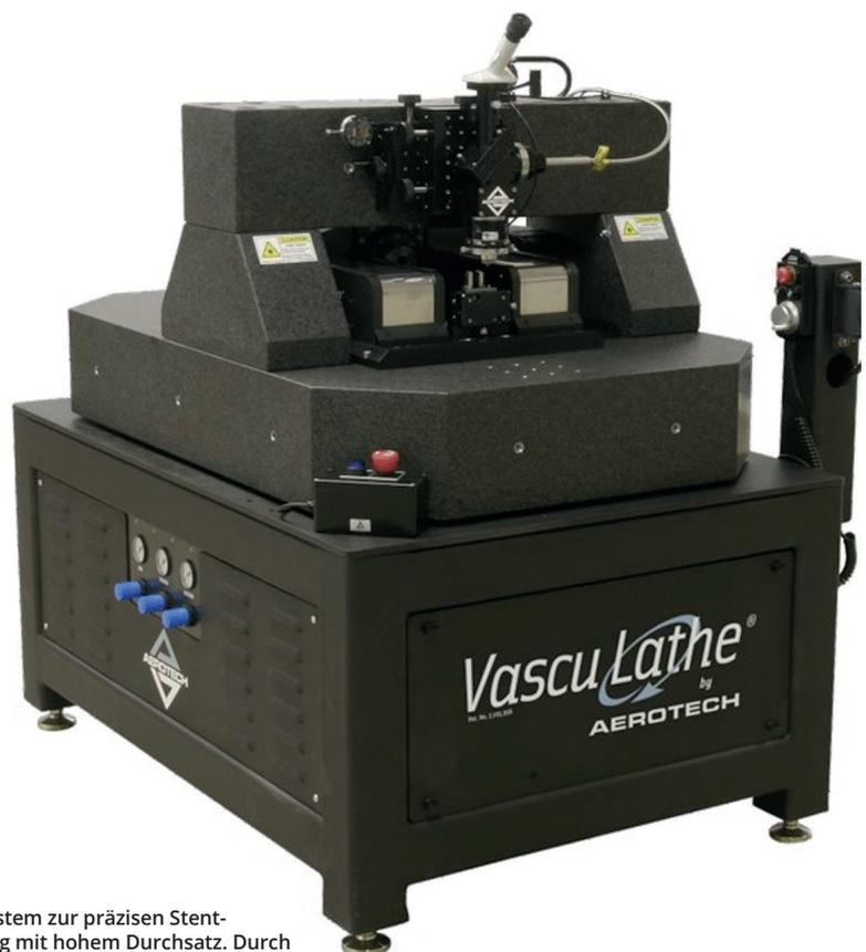
Schneidsystem zur präzisen Stent-Herstellung mit hohem Durchsatz. Durch die flache Konstruktion mit parallel angeordneten Strukturelementen erhält man eine sehr steife Struktur. Es kann also mehr Energie eingebracht werden, ohne dass die Maschine wackelt. Auf diese Weise werden weniger Teilefehler verursacht.
