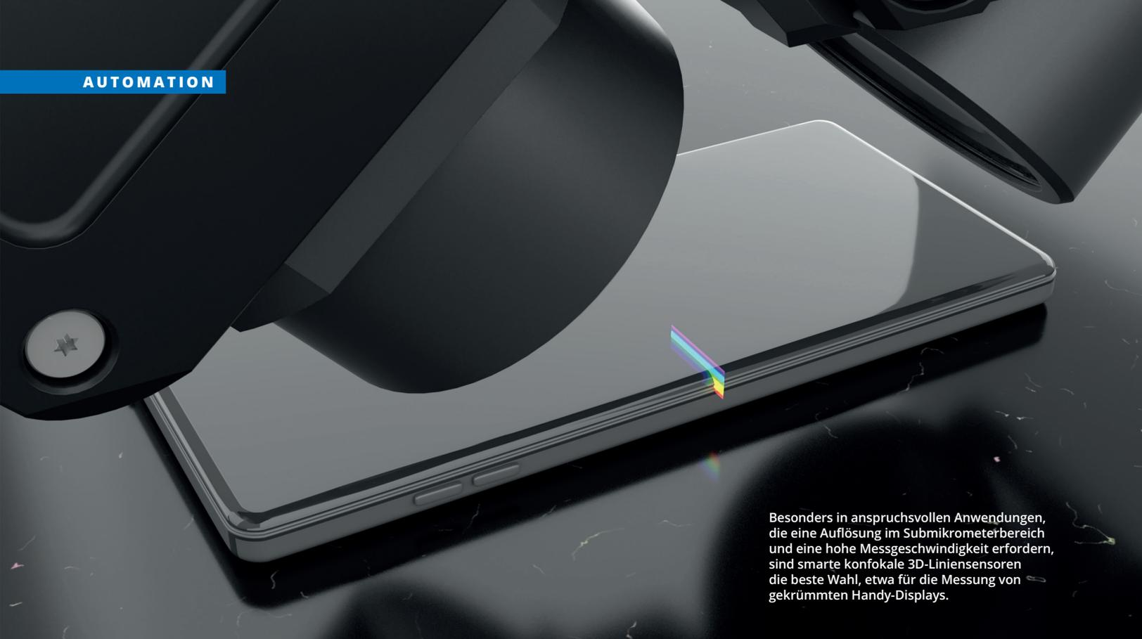
Besonders in anspruchsvollen Anwendungen, die eine Auflösung im Submikrometerbereich und eine hohe Messgeschwindigkeit erfordern, sind smarte konfokale 3D-Liniensensoren die beste Wahl, etwa für die Messung von gekrümmten Handy-Displays.
