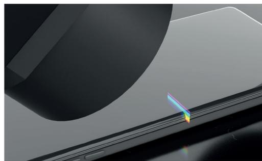
**36** Konfokale 3D-Liniensensoren für die Prüfung von anspruchsvollen Materialstrukturen
