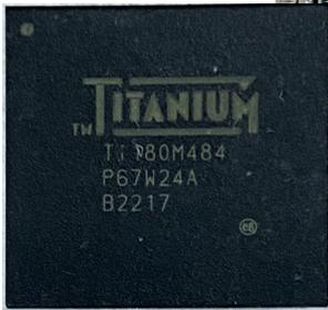
Der Titanium Ti180 FPGA ist das neueste Mitglied der Titanium-Familie und wird im 16-nm-Prozess gefertigt.
