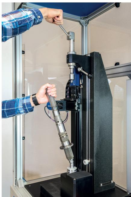
Das Volkswagenwerk Kassel setzt die Optoshaft-Messmaschine von Optosurf in der Qualitätssicherung von Getriebewellen ein.
