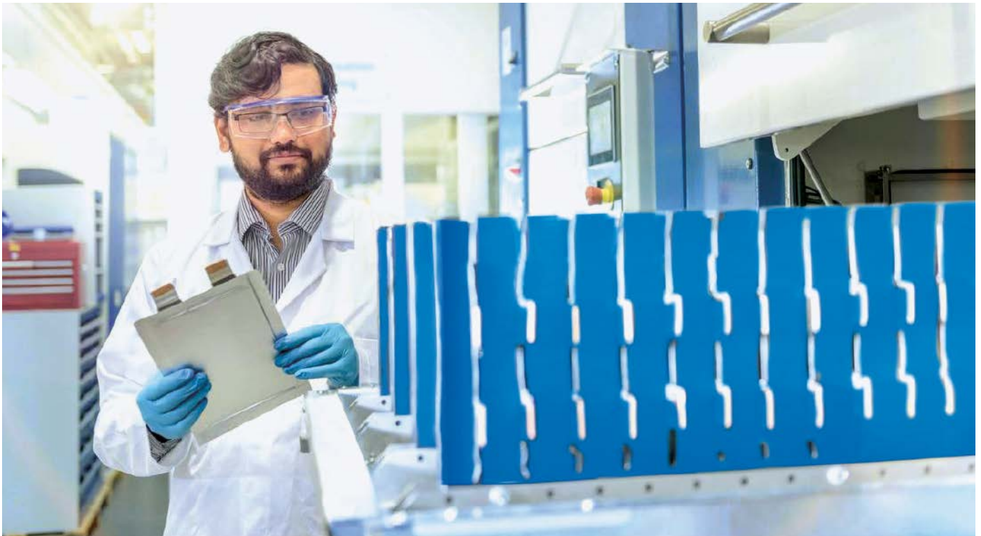
Das Gehäuse wird mit einem hellblauen UV-Lack beschichtet. Da die Beschichtungsdicke eine funktionskritische Kenngröße ist, wird diese präzise und dokumentationsicher gemessen.
