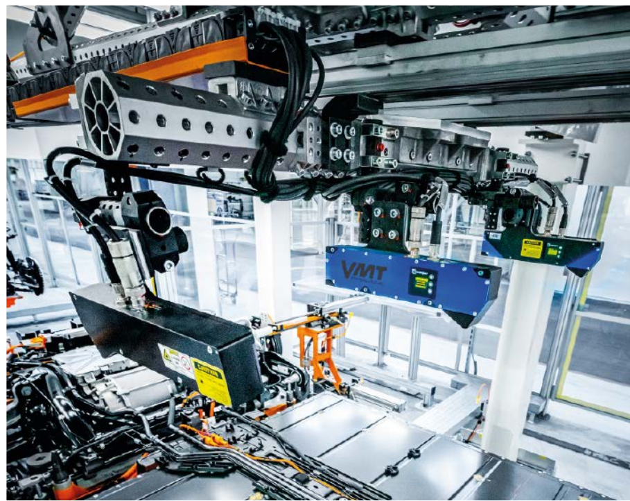
Paarweise gegenläufig angeordnete Laser-Triangulationsensoren ermöglichen hinterschneidungsfreie Scans.
