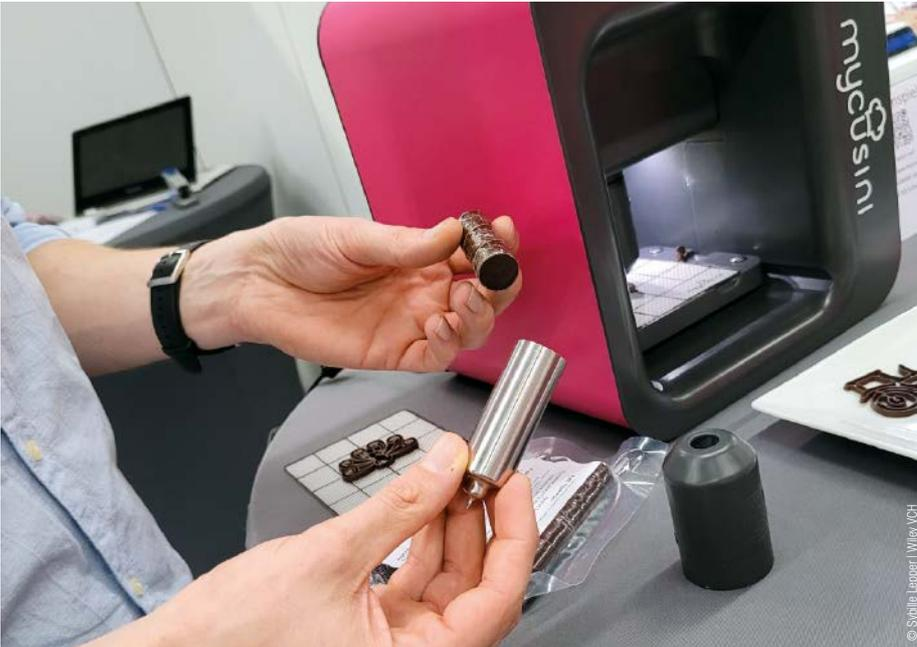
Der 3D Choco Refill wird in eine Edelstahlkartusche eingesetzt.
