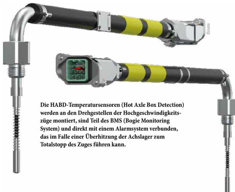
Die HABD-Temperatursensoren (Hot Axle Box Detection) werden an den Drehstellen der Hochgeschwindigkeitszüge montiert, sind Teil des BMS (Bogie Monitoring System) und direkt mit einem Alarmsystem verbunden, das im Falle einer Überhitzung der Achslager zum Totalstopp des Zuges führen kann.
