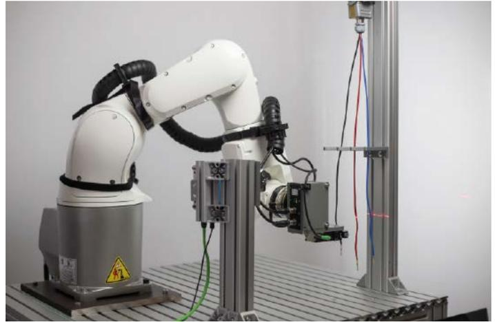
Minds RPS ermöglicht hier die vereinfachte Erstellung von hochadaptiven Roboterprogrammen, die ohne zusätzliche Hardware auf der Standardsteuerung des gewünschten Industrieroboters ausgeführt werden. Gleichzeitig ist die Software auch für die Integration des Laserscanners über eine eigens entwickelte Schnittstelle zuständig. [www.artiminds.com](http://www.artiminds.com)
