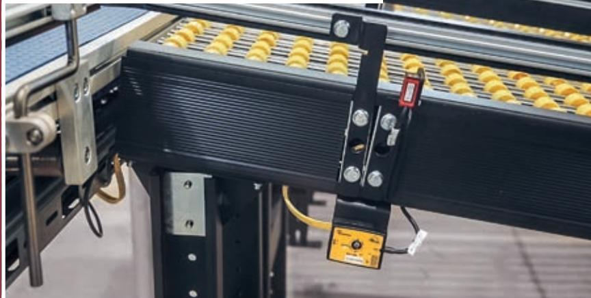
Zusätzlich zum Tracking über den SKU-Barcode wird eine RFID-Kontrolllesung durchgeführt, die die CLUSTAG-RFID-Technologie von RIELEC nutzt. Diese Technologie ermöglicht es zum Beispiel, falsch codierte Etiketten zu identifizieren und zu korrigieren. Auf diese Weise werden Fehlerquellen beseitigt und die neuen Daten dem System in Echtzeit zur Verfügung gestellt, was die Produktivität der Applikation noch einmal erheblich steigert.
