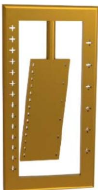
Aufbau der Neigungssensoren KAS: Durch die Neigung in horizontaler Richtung (nach rechts) neigt sich der Biegebalken. Dies ergibt eine (positive) Kapazitätsveränderung, deren hohes Nutzsignal sehr rauscharm ist.
