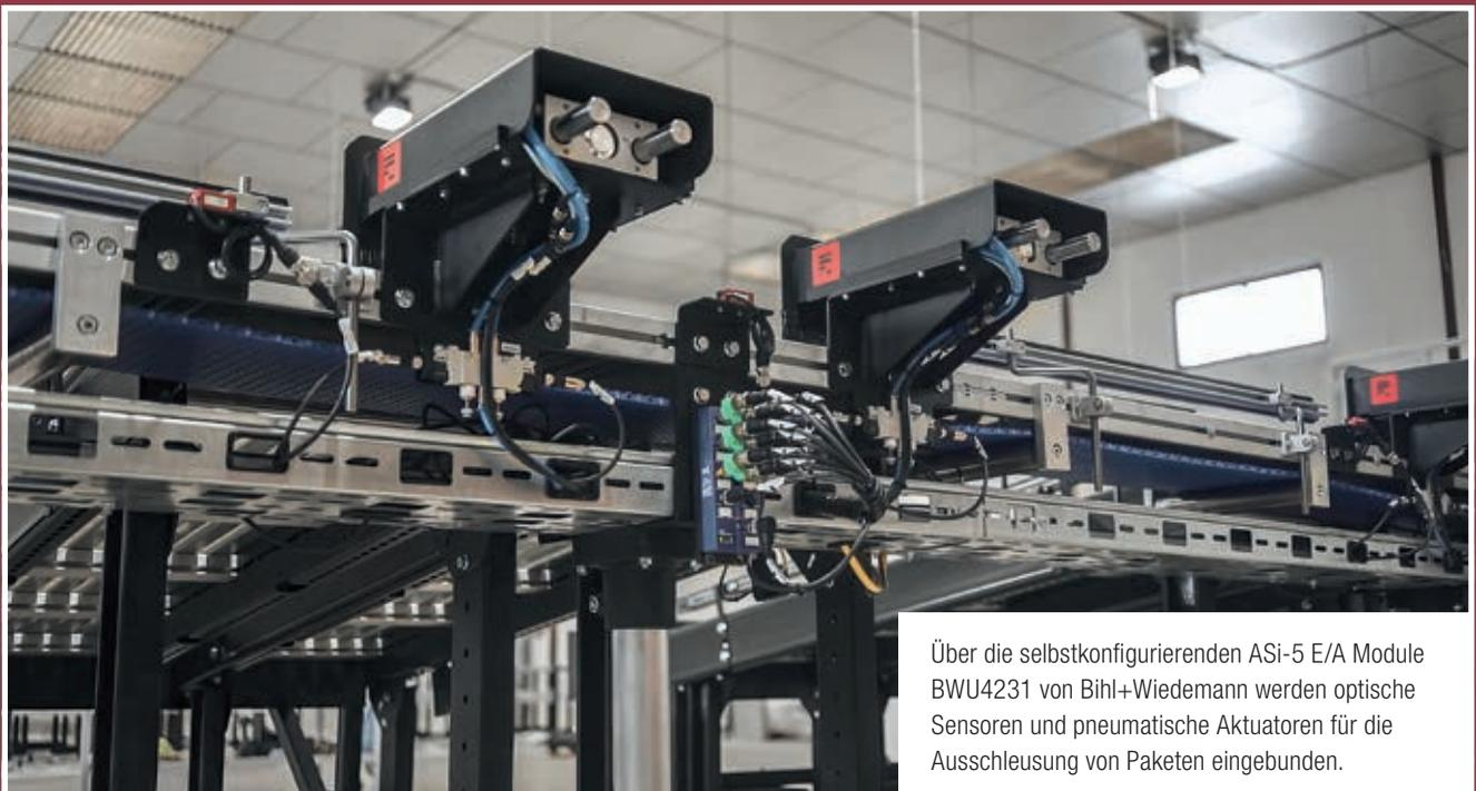
Über die selbstkonfigurierenden ASI-5 E/A Module BWU4231 von Bihl+Wiedemann werden optische Sensoren und pneumatische Aktuatoren für die Ausschleusung von Paketen eingebunden.
