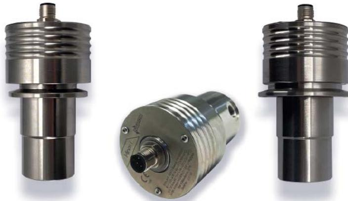
Der galvanische Brennstoffzellen-Sauerstofftransmitter Minox i ist ein zuverlässiger und kosteneffizienter, schleifengespeister 2-Draht-Transmitter mit einem 4-20 mA-Ausgang.
