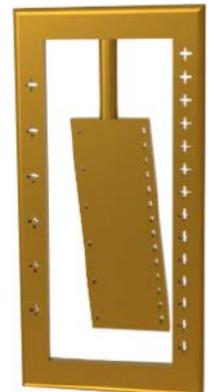
Durch die Neigung oder Beschleunigung in die entgegengesetzte Messrichtung ergibt sich ein negatives Signal. Daher spricht man von zum Beispiel + 90° und - 90° also ± 90°.
