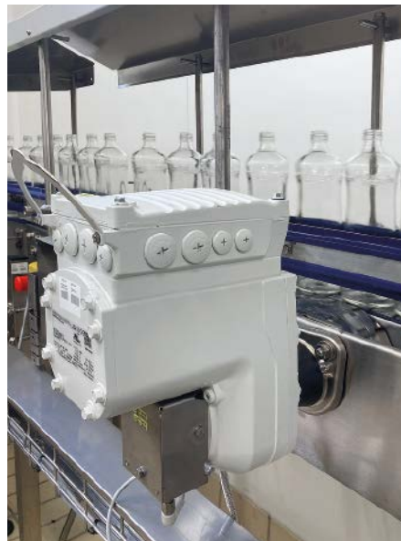
Damit die frisch gereinigten Flaschen sauber bleiben, hat der Behältertransport für leere Flaschen – angetrieben durch Movigear Classic – auf dem Weg zum Füller zusätzlich ein Schutzdach.
