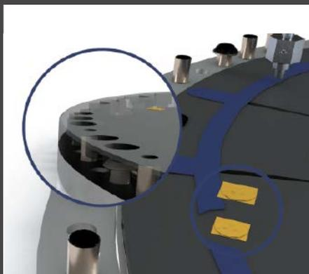
Ein eigens entwickeltes Integrationskonzept garantiert die optimale Positionierung der Sensoren am und im Klemmsystem.
