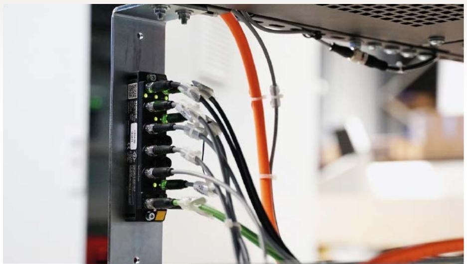
Das TBEN-S1-Modul zählt in Hochgeschwindigkeit Zähne und sorgt für den reibungslosen Betrieb des Pocket Sorters.
