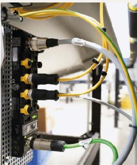
Die dezentrale Signalverarbeitung durch das hybride Safety-I/O-Modul TBPN für Profinet/ProfiSafe erlaubt ein höheres Fördertempo der Anlage.
