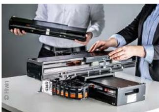
Die hochpräzisen Kreuztische und Gantry-Systeme von Hiwin sorgen für Wiederholgenauigkeiten im  $\mu\text{m}$ -Bereich. Herzstück dieser Präzisions-Systeme sind Hiwin-Linearmotoren
