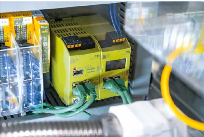
Die Industrie-Firewall SecurityBridge von Pilz schützt Steuerungen vor Angriffen und unautorisiertem Zugriff. Zudem kontrolliert sie die Datenkommunikation innerhalb eines Automatisierungsnetzwerks.
