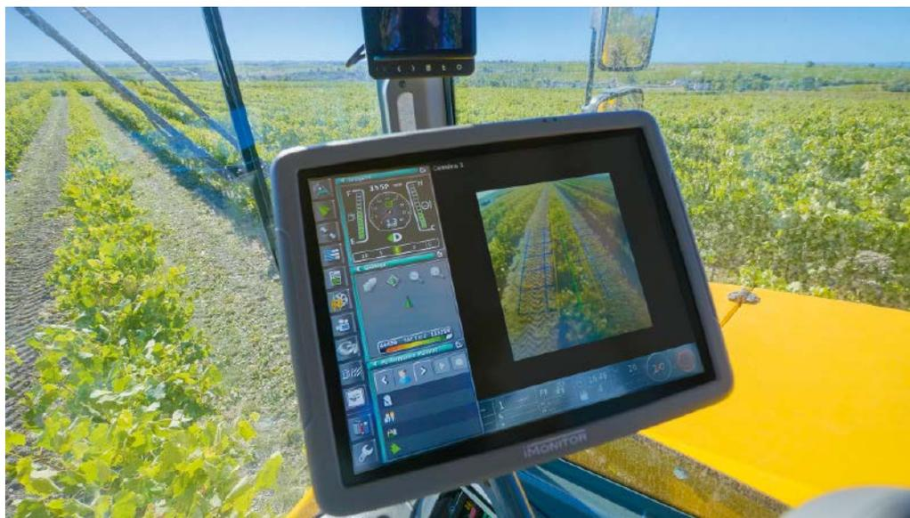
Wenn sich die Maschine in der Rebzeile befindet, startet der Fahrer den Easypilot über den Bildschirm, der sich in der Fahrerkabine befindet. Nach Starten des Systems muss der Fahrer nur noch die Arbeitsgeschwindigkeit und die Überwachung der Werkzeuge im Auge behalten, den Rest erledigt das System automatisch.
