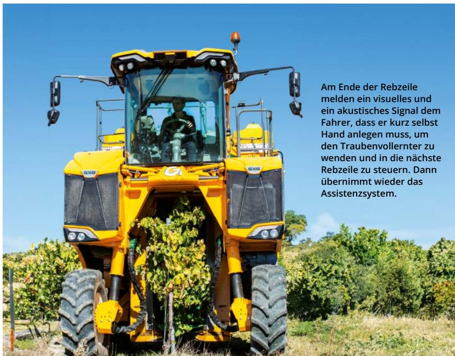
Am Ende der Rebzeile melden ein visuelles und ein akustisches Signal dem Fahrer, dass er kurz selbst Hand anlegen muss, um den Traubenvollernter zu wenden und in die nächste Rebzeile zu steuern. Dann übernimmt wieder das Assistenzsystem.
