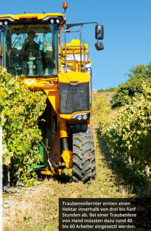
Traubenvollernter ernten einen Hektar innerhalb von drei bis fünf Stunden ab. Bei einer Traubenernte von Hand müssten dazu rund 40 bis 60 Arbeiter eingesetzt werden.
