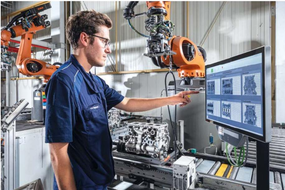
Sofern die KI ein Kurbelgehäuse als fehlerhaft bewertet hat, kommt es bei einem der beiden Werker an. Dieser bekommt auf seinem Monitor die Visualisierung des Fehlerortes auf einem Rasterkatalog des Bauteils angezeigt.
