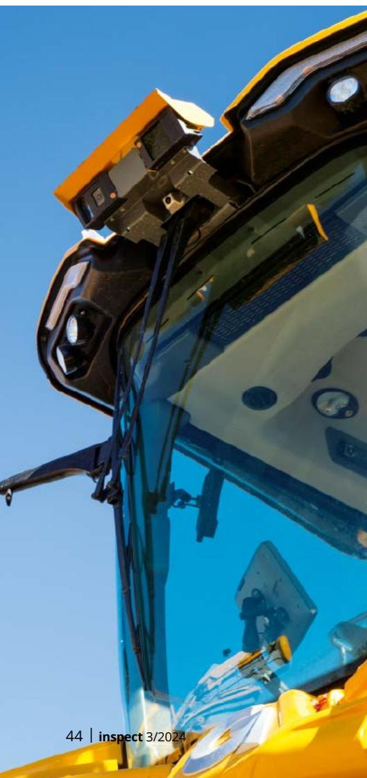
Mit dem Easypilot bietet Grégoire, Hersteller von Geräteträgern und Obstvollerntern, ein System zur automatischen Linienführung mittels Sensoren – und das mit einer Präzision von 3 cm ohne GPS-Positionssignal. Möglich machen das 3D-Kameras, die nach dem Time-of-Flight-Prinzip arbeiten.
