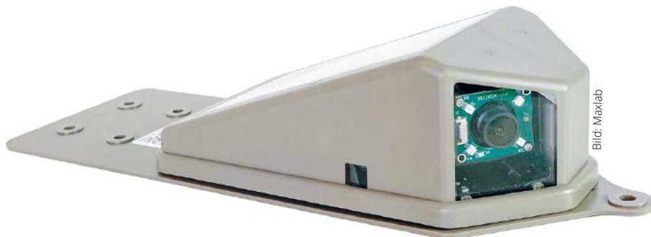
Das Maxlab-System besteht aus einem oder mehreren Kameramodulen (je nach Größe des Daches), die den Schnee- und Eisstand am Rand des Daches überwachen und die Heizkabel nur bei Bedarf aktivieren.
