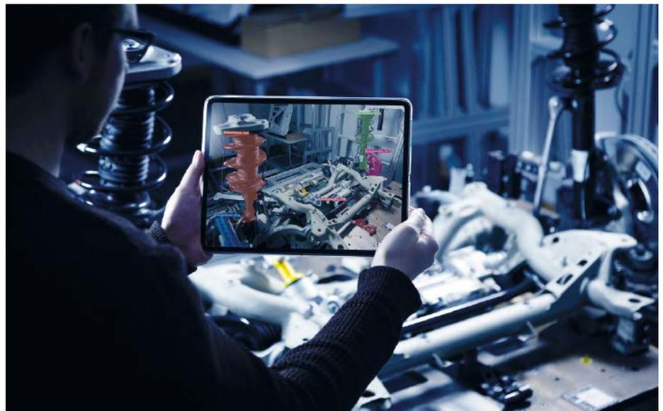
Das Fraunhofer IGD arbeitet an Lösungen zur KI-basierten Qualitätssicherung. Das Programm „Marquis“ bietet eine visuelle Inspektion während des laufenden Montageprozesses und kann auch die zugehörige Dokumentation abbilden.
