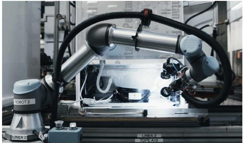
Mit KI-basierten Vision-Systemen, wie Mirai von Micropsi, können Anwender dem Roboter mögliche Varianten ganz einfach zeigen – beispielsweise unterschiedlich aussehende Rohre in der Leckageprüfung von Kühlschränken bei BSH Hausgeräte.
