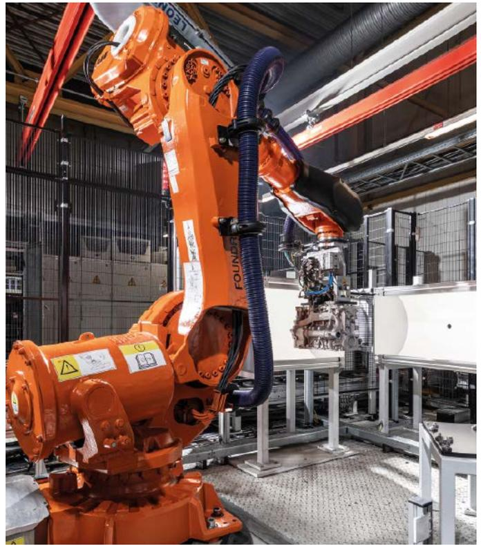
Der Roboter erkennt das Bauteil und greift es vom Förderband lagerichtig je nachdem, ob es ein Drei-, Vier- oder Sechszylinder-Kurbelgehäuse ist.
