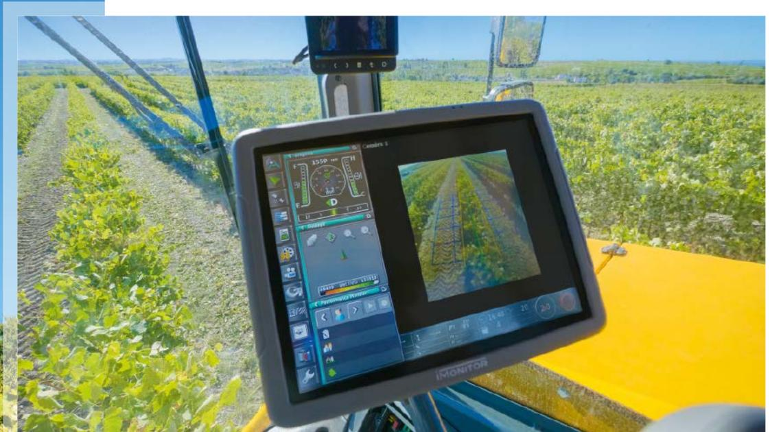
Das automatische Linienführungssystem EasyPilot übernimmt das Lenken des Traubenvollernters.
