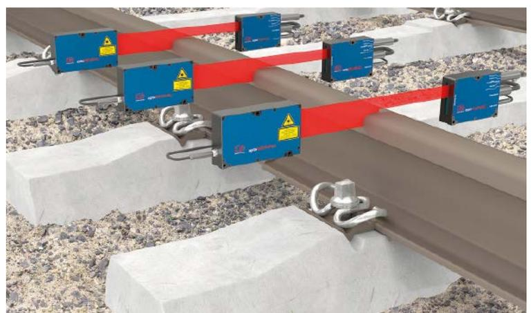
Ebenheit und Durchbiegung der Gleise sind kritische Faktoren für Sicherheit und Effizienz im Schienenverkehr. Um diese Parameter präzise zu überwachen, setzen Bahnbetreiber auf Messtechnologien wie die Präzisionsmikrometer OptoControl.
