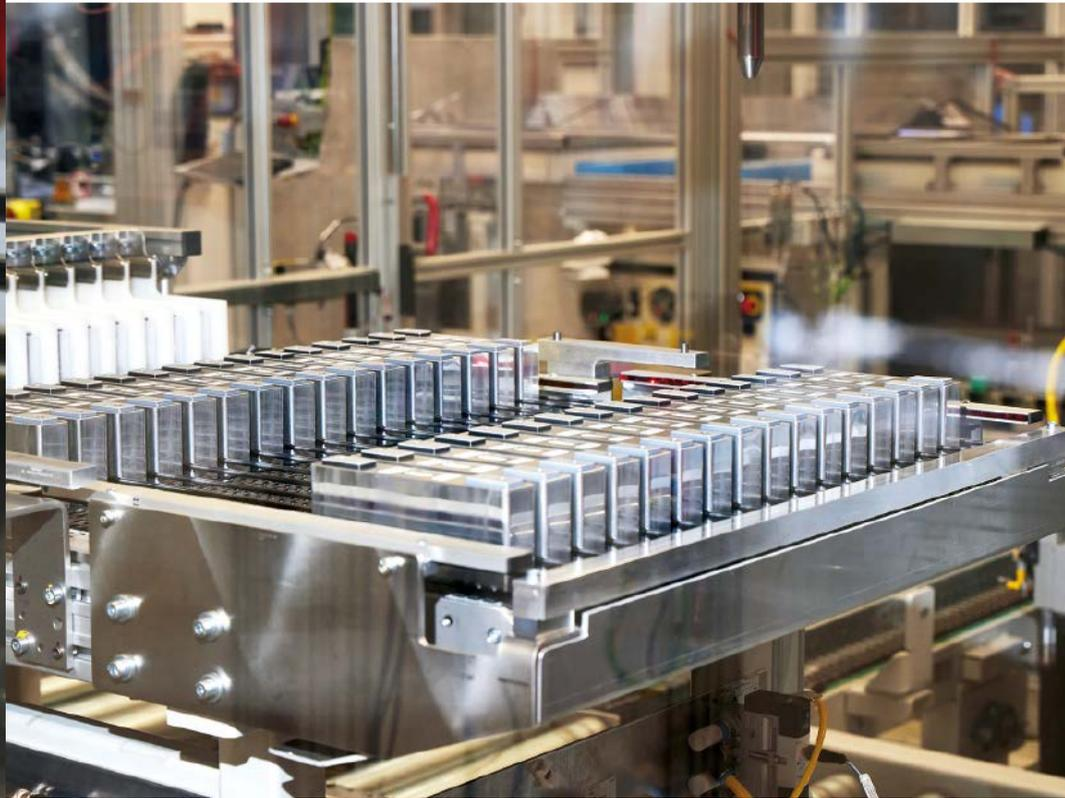
Ein Roboter platziert die aus einem Großladungsträger entnommenen Zellen auf dem Förderband. Hier detektieren waagrecht installierte, schaltende Lichtvorhänge der Serie CSL, ob die Zellen korrekt platziert sind.
