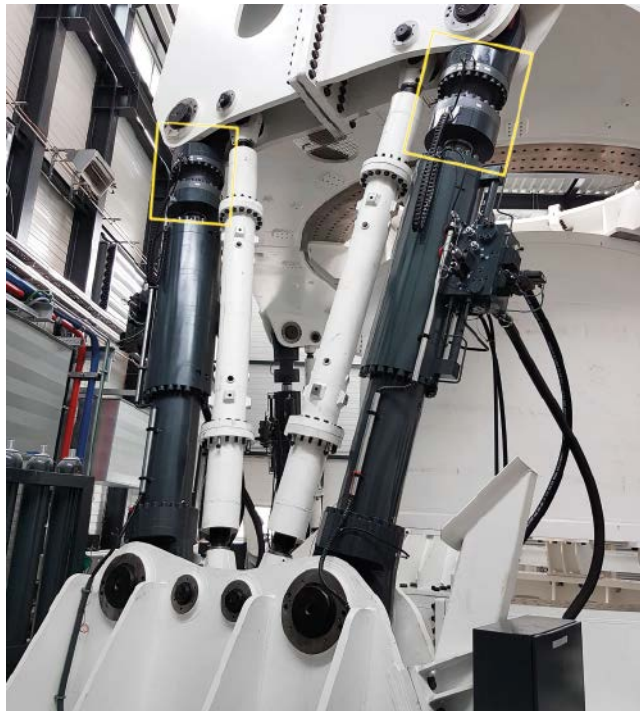
GTM-Kraftaufnehmer Serie RF in einem Hochlastprüfstand für Gondeln und Rotornaben von Windkraftanlagen – zum Einsatz kommen kundenspezifische Sensoren mit einem Nennkraftbereich von 10 MN.
