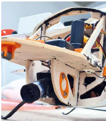
Die USB3-Vision-Farbkamera Exo267CU3 von SVS-Vistek sorgt in der Evolonic-Drohne für aussagekräftige Bilder und ist nur bei abmontierter Außenhaut der Drohne erkennbar. Eine KI-Software wertet die Bilder anschließend aus und übermittelt die Koordinaten der möglichen Rauchwolken an die Einsatzzentrale.
