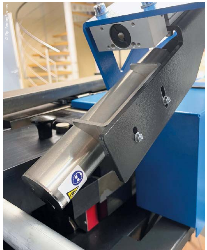
Igus schneidet die Lineareinheit der Serie Drylin SLW-1040 millimetergenau auf die Maschinen von PBS zu.
