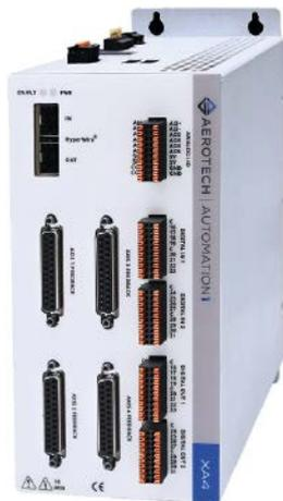
Aerotech hat seine Bewegungssteuerungsplattform Automation1 erweitert. Die Version 2.8 bietet eine anpassbare CNC-Benutzeroberfläche und unterstützt die neue 4-Achsen-Version der XA4-Steuerungsserie. Laut Hersteller reagiert man da auf Kundenanforderungen. Neue Funktionen umfassen eine erweiterte Gleichstromversorgung (100 VDC) und E/A-Erweiterungsplatinen EB1 und EB2. Die Plattform unterstützt nun die Setup-Wizard-Integration für Linearportale.
