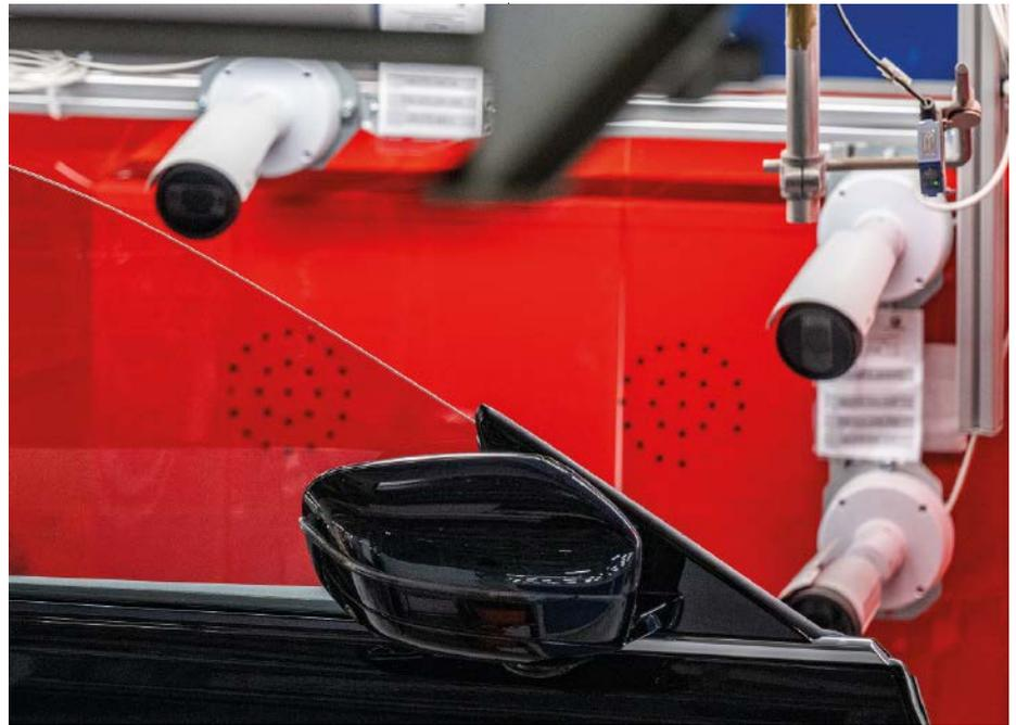
Insgesamt werden bei BMW mehr als 600 Merkmale eines neuen Fahrzeugs geprüft – wie beispielsweise der Türschließbügel. Dank der automatisierten Qualitätssicherung werden Montagemängel in Echtzeit an die Mitarbeitenden am Band zurückgemeldet, die diese im Idealfall beheben, bevor das Fahrzeug den nächsten Produktionsschritt erreicht.
