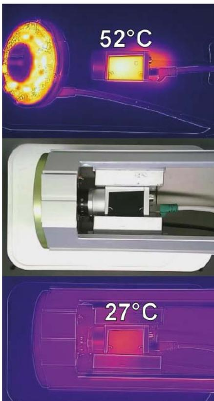
Effektive Wärmeableitung: Die Kameras sind innerhalb der Gehäuse um 25 K kühler als außerhalb.
