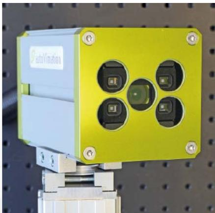
Die fünf separaten, ins Stingray-Schutzgehäuse eingebrachten Frontscheiben vermeiden eine Rückspiegelung der LED-Blitze der Time-of-Flight-Kameras in das Objektiv.
