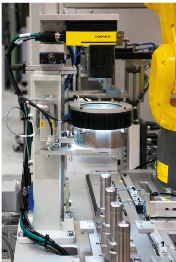
Hier ist die Kamerastation mit den noch unbestückten Aufnahmedornen des Querschlittens zu sehen. Der silberne Zylinder unter der großen Linse enthält die selbstentwickelte Spezialoptik für 360°-Aufnahmen
