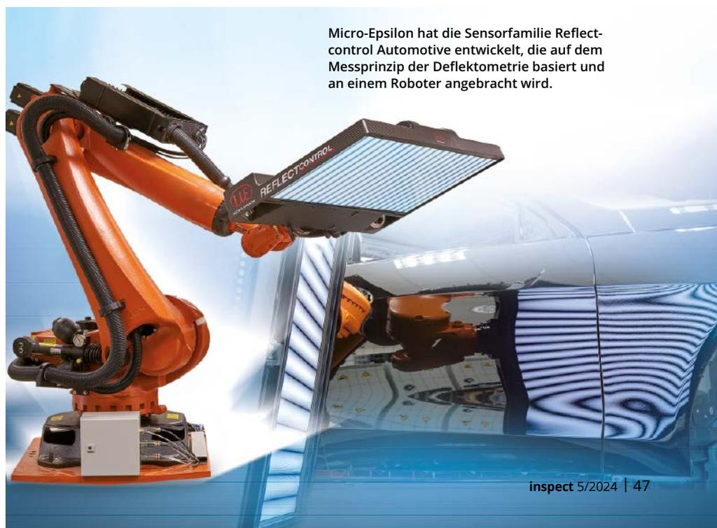
Micro-Epsilon hat die Sensorfamilie Reflect-control Automotive entwickelt, die auf dem Messprinzip der Deflektometrie basiert und an einem Roboter angebracht wird.
